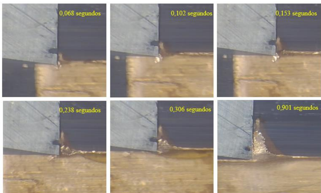
Figura 123: Corte derivativo com deformação inicial na ferramenta SG0.25 ( t_1 = 0,10 mm)
