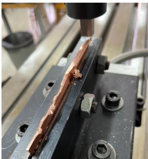
Figura 29: Deformação excessiva do material do corpo de prova.
