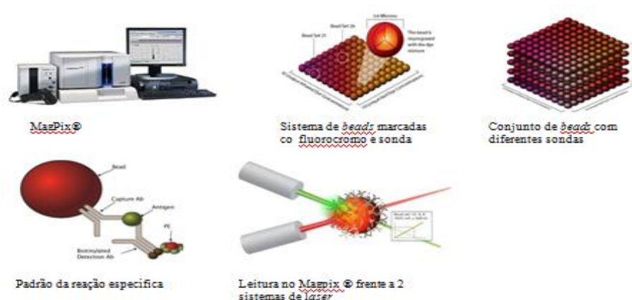
Figura 11 – Sistema Luminex – Plataforma de monitoramento dos Fatores de Crescimento
