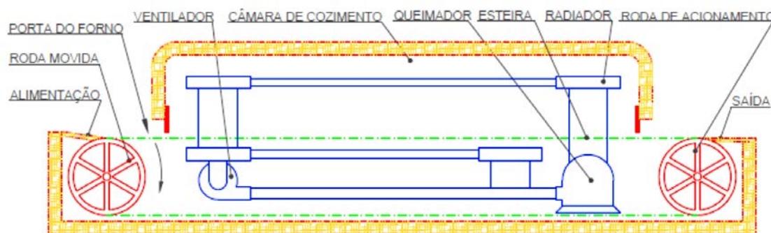
Figura 2.4 – Forno tipo túnel (Fonte: Matz (1992) – Adaptada).
