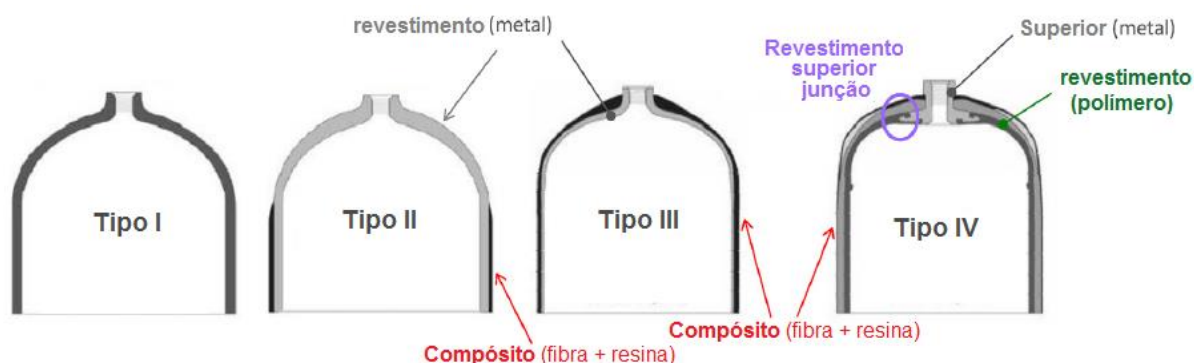
Figura 19 - Tipos de tanques para armazenamento de hidrogênio gasoso comprimido
