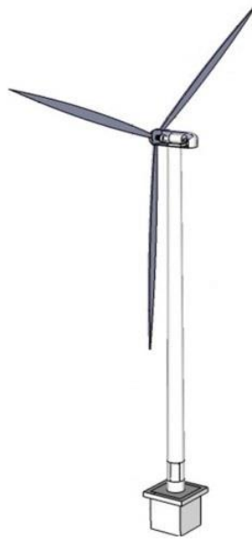
Figura 11 - Esquema de uma turbina eólica de eixo horizontal
