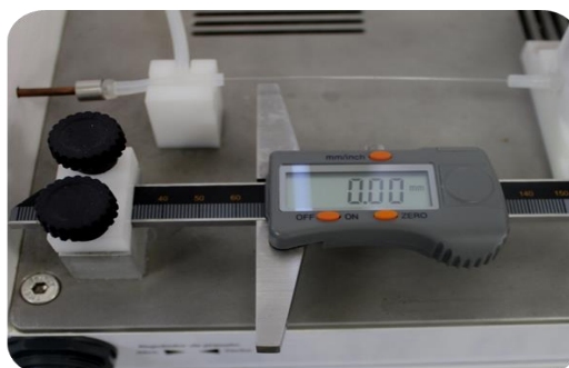
Figura 7 – Paquímetro digital, o qual medirá a taxa de movimento do fluido através da dentina pelo deslocamento linear da bolha de ar.
