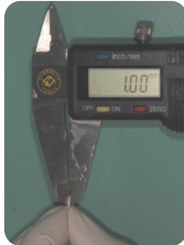
Figura 4 – espessura final do espécime sendo medida por meio de um paquímetro digital.
