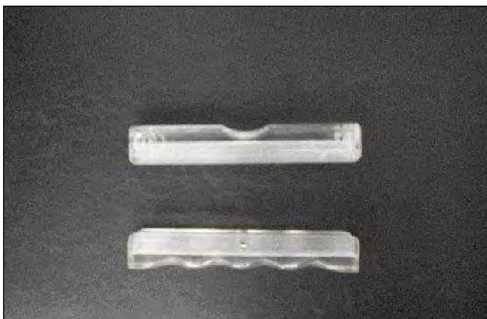
Figura 4.7- Moldes para avaliação da força flexora do polegar.
