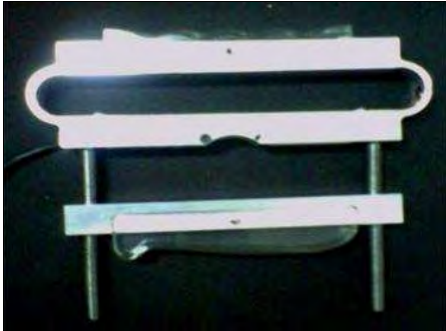
Figura 4.1 - Estrutura mecânica do dinamômetro.
