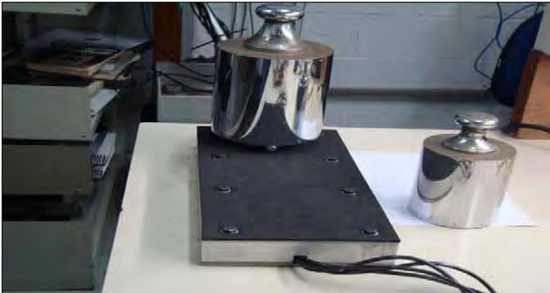
**Figura 5.21** - Aplicação de força de 98 N na plataforma.
