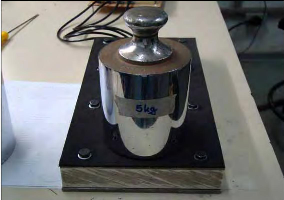
**Figura 5.19** - Aplicação de força de 49 N na plataforma.
