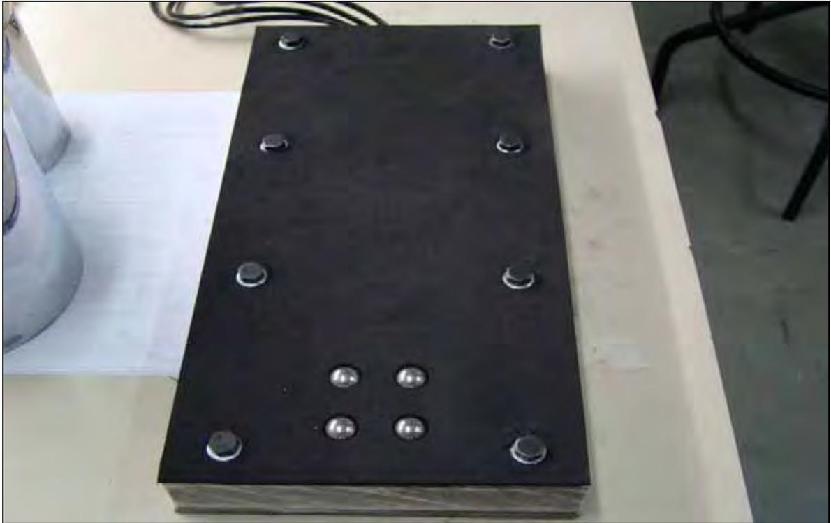
**Figura 5.18** - Plataforma de força com as quatro células.
