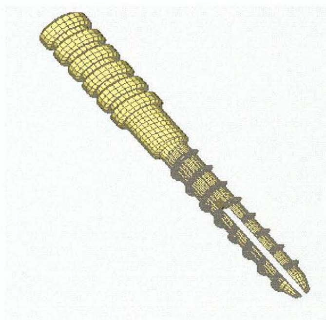
FIGURA 4 – Demonstra em detalhes a configuração do pino, das roscas e da fenda aberta.
