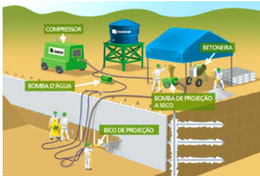
Figura 7 – Arranjo de equipe e equipamento para concreto projetado por via seca
