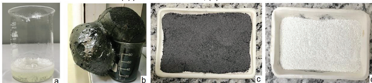
Figura 14 – Síntese de ZnO NPs por Pechini. (a) resina polimérica - poliéster; (b) puff de poliéster; (c) poliéster macerado; (d) ZnO NPs.
