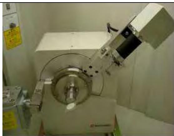
**Figura 3.11:** Ensaio em andamento – detalhe do equipamento de difração.
