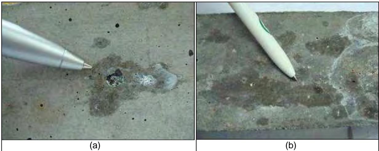
**Figura 4.23:** Erosão e eflorescência nos prismas de concreto. a) Amostra B1 – fenômeno pontual e b) Amostra G2 – fenômeno em toda barra com presença de fissuras
