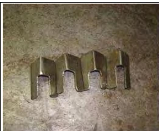
**Figura 3.19:** Separadores utilizados para segmentar as barras
