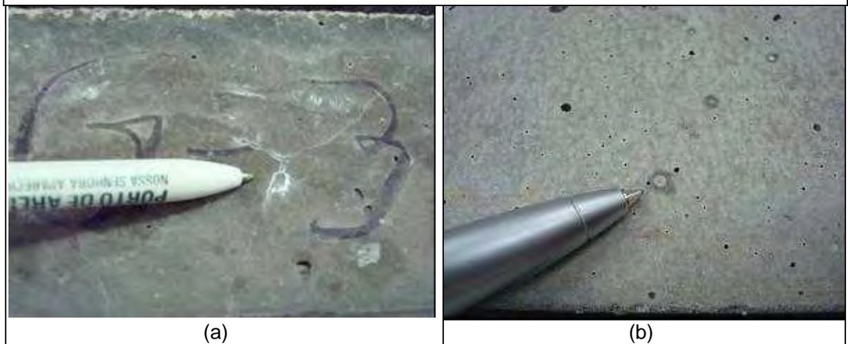
**Figura 4.24:** Ensaio acelerado em prismas de concreto. a) Fissuras contínuas na região central do concreto G3 e b) Poros com bordas escuras em M2.
