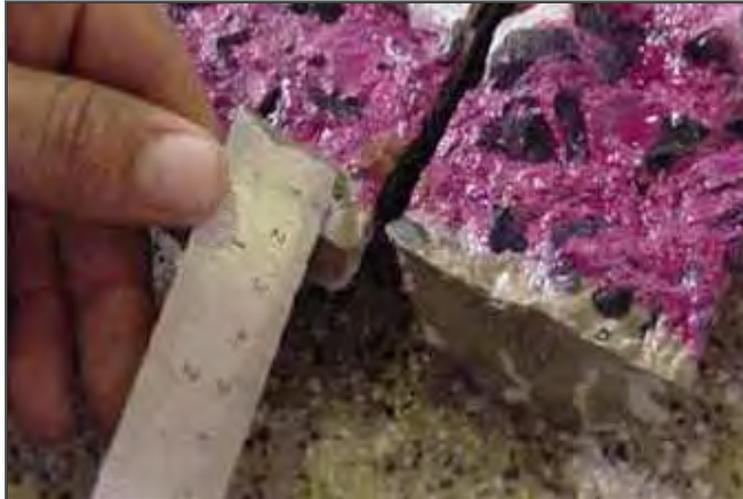
**Figura 1.16:** Medida da profundidade de carbonatação - teste fenolftaleína.
