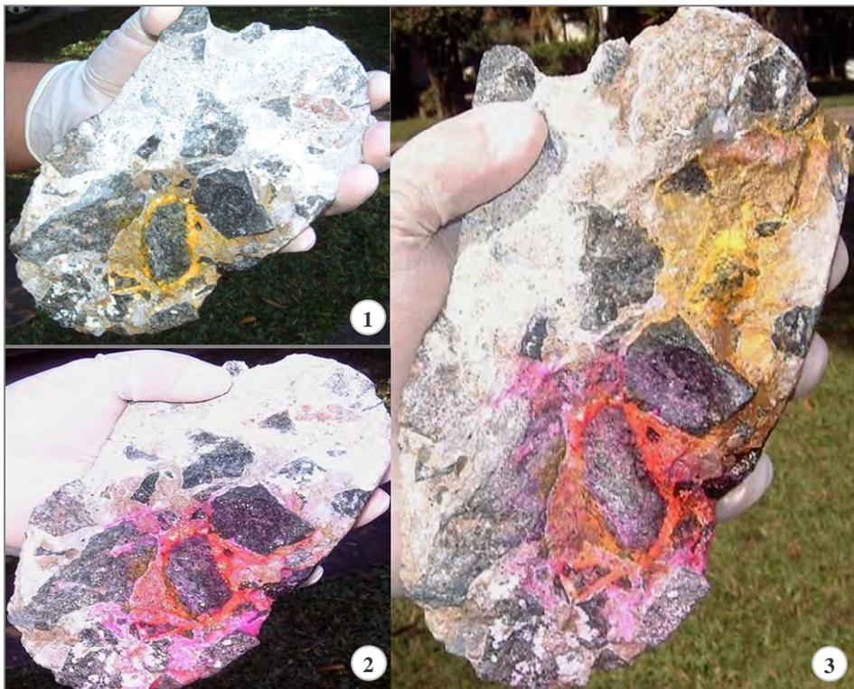
**Figura 2.3:** Teste colorimétrico em concreto afetado pela RAA, seqüência de impregnação: 1) Solução Na-cobaltonitrito, 2) Solução rodamina B base e 3) Constatação da RAA
