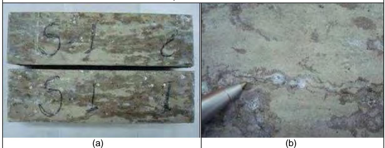
**Figura 4.25:** Prismas de concreto – amostra S1. a) Desgaste superficial e eflorescências na superfície do concreto, b) Fissuras contínuas nas regiões degradadas.
