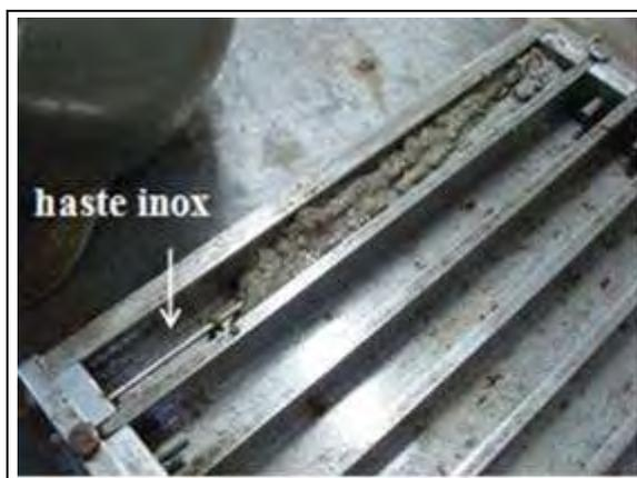
**Figura 3.18:** Detalhe da moldagem – fôrma com haste guia de inox
