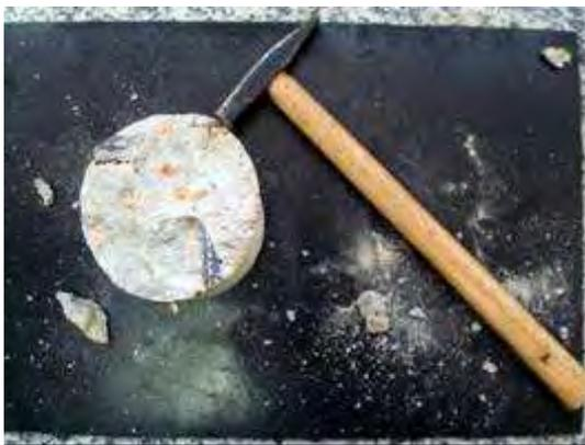
**Figura 3.30:** Preparo das amostras por fratura
