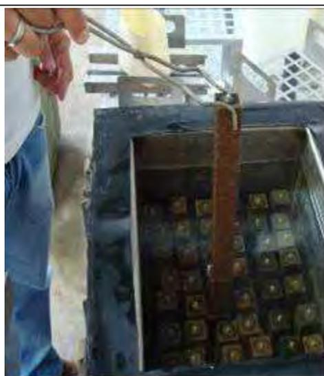
**Figura 3.15:** Instante de retirada da barra do banho térmico
