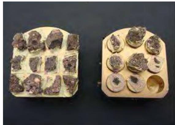
**Figura 3.31:** Amostras recobertas com ouro no porta-amostra para análise no MEV e EDS
