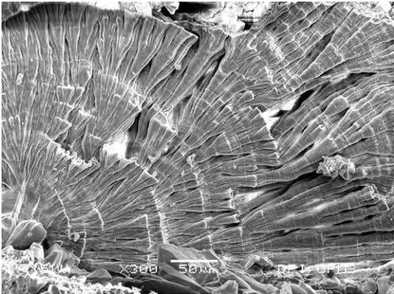
**Figura 4.27:** Micrografia da amostra T1.1-xerogel de carbonato de cálcio
