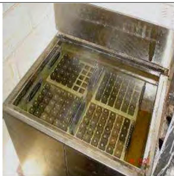
**Figura 3.14:** Banho térmico NaOH 1N controlado à  $80^{\circ}\text{C}$ .
