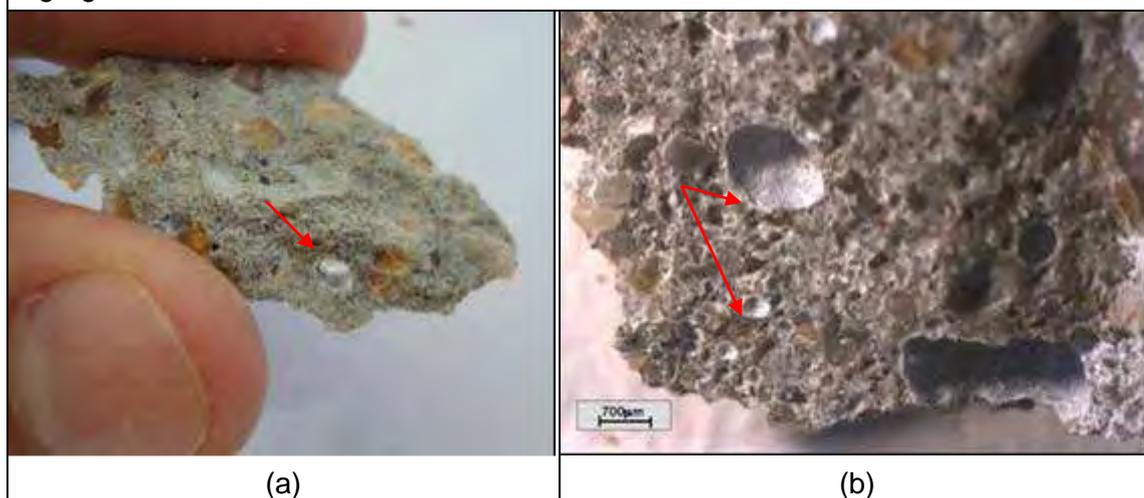
**Figura 4.10:** Inspeções visuais com microscópio estereoscópico no testemunho T3. a) Detalhe do poro preenchido com xerogel, b) Possível processo de formação do xerogel observado em muitos poros.
