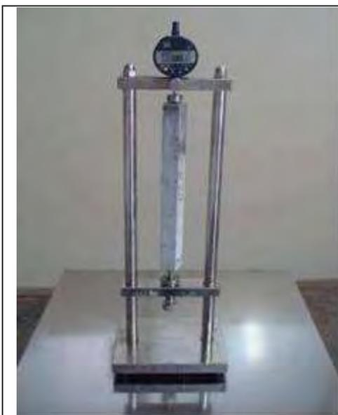
**Figura 3.13:** Equipamento de leitura de expansões.
