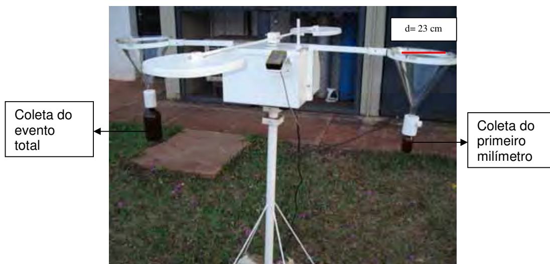
Figura 5 - Foto do coletor automático utilizado para a coleta de água de chuva.
