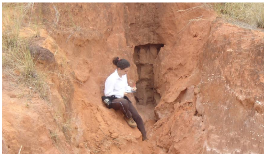
Figura 7: Um dos pipes encontrados no local com aproximadamente 1m de altura e 0,3m de profundidade.
