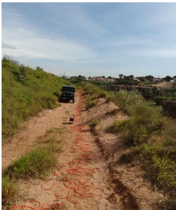
Figura 14: Detalhe da linha. Eletrodos fincados no solo com espaçamento de 1m.
