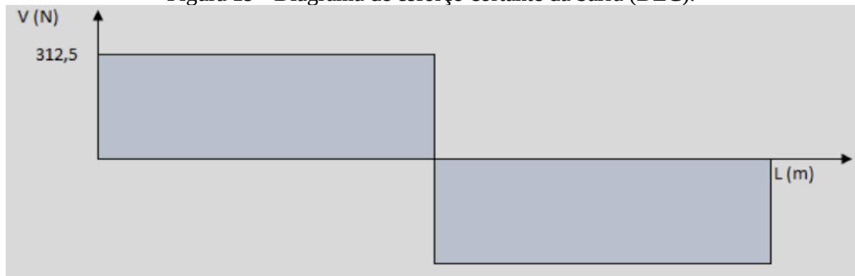
Figura 19 - Diagrama de esforço cortante da barra (DEC).
