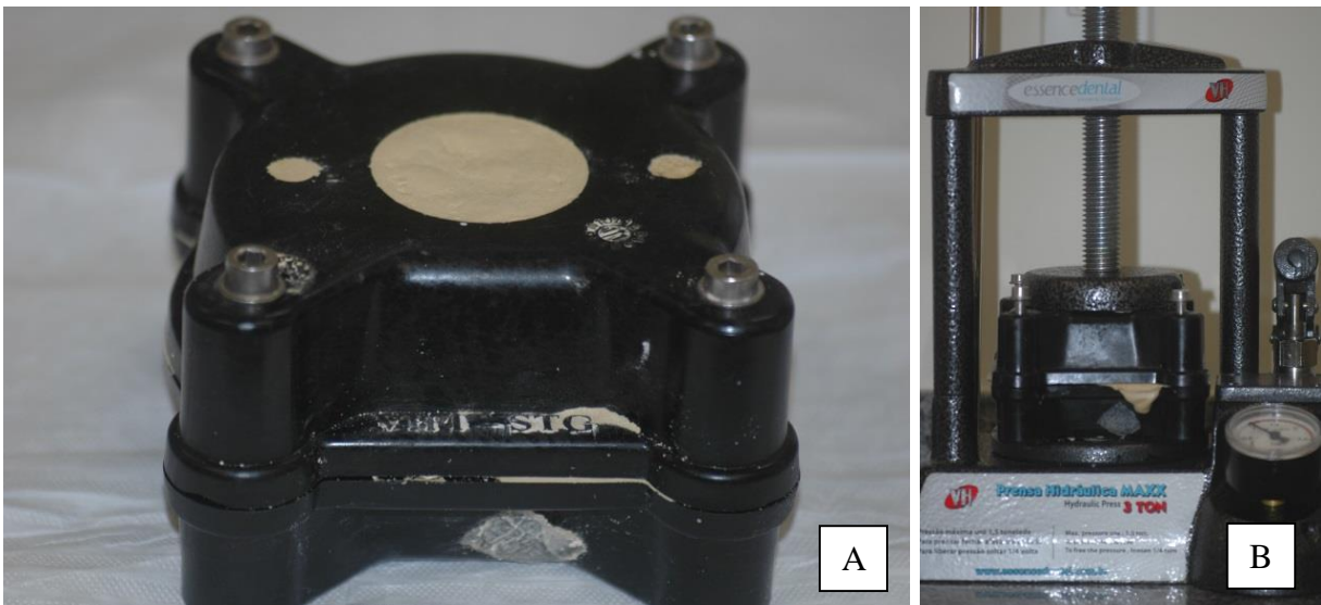
Figura 10 - (A) Mufla preenchida com gesso pedra tipo III. (B) Prensa hidráulica de bancada
