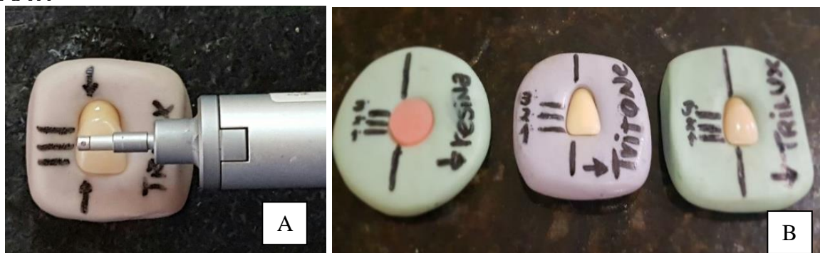
Figura 11 - (A) Leitura realizada no rugosímetro no sentido transversal ao longo eixo dos dentes. (B) Matrizes de silicone de condensação individualizadas de acordo com o formato de cada amostra de dente artificial e RAAT.
