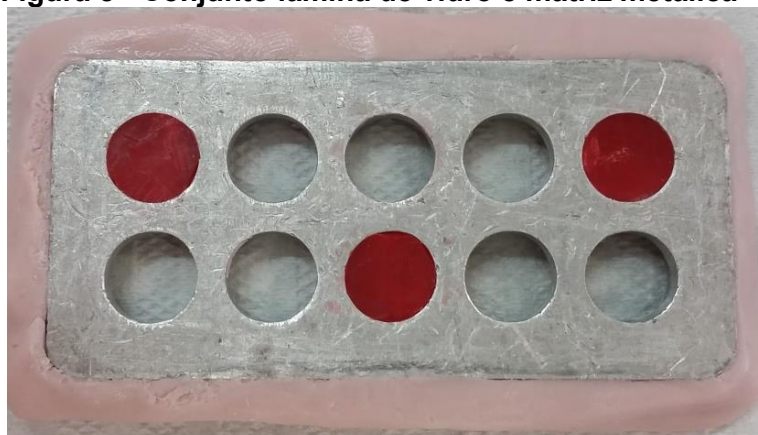
Figura 8 - Conjunto lâmina de vidro e matriz metálica
