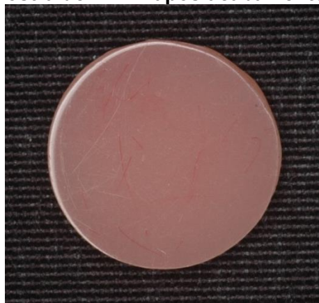
Figura 7 - Amostra de RAAT após acabamento e polimento
