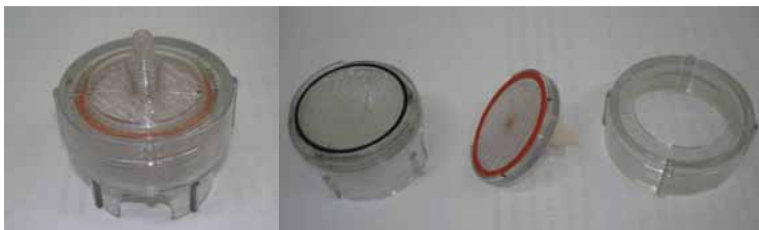
Figura 8 – Suporte de filtro usado em amostrador de pequeno volume.
