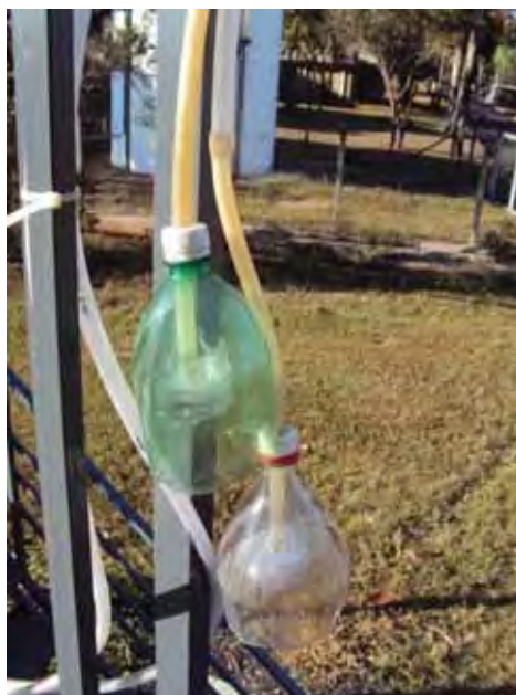
Figura 10 - Sistema de amostradores de pequeno volume com proteção contra a chuva.
