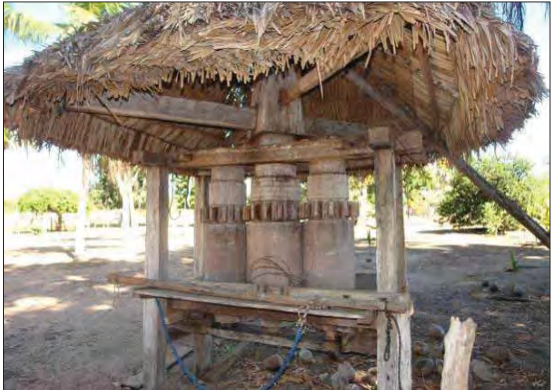
Figura 41 – Moenda de cana artesanal em madeira, coberta com fibra de Buriti; ela é movida à tração animal (bois amansados); o caldo da cana é depois transformado em melado e principalmente em rapadura, em outra estrutura ao lado da moenda. É uma das principais fontes de alimento da população dessa região, além da farinha e proteína animal.
