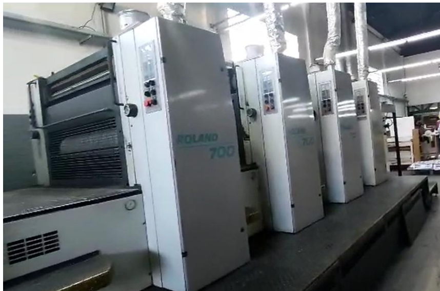
Figura 8 - Máquina de impressão das embalagens.
