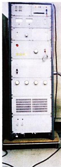
FIGURA 3.22 – Gerador utilizado para produzir tensão pulsada no reator
