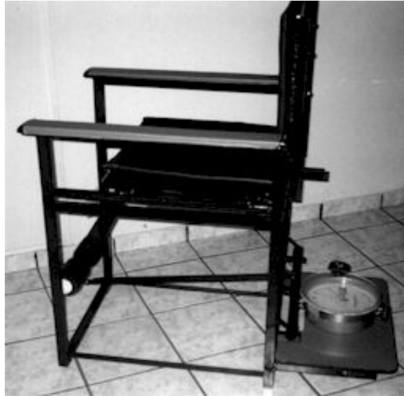
Figura 7 – Dinamômetro analógico. Adaptada de Canto et al (2004).
