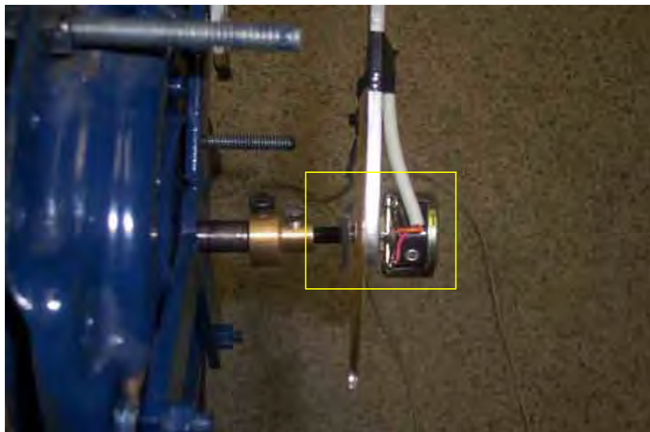
Figura 17 – Potenciômetro instalado junto ao eixo de rotação.
