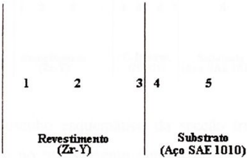
FIGURA 4.1 – Desenho esquemático da secção transversal da cratera de erosão no revestimento depositado em substrato de aço, indicando os pontos em que foram feitas as análises.
