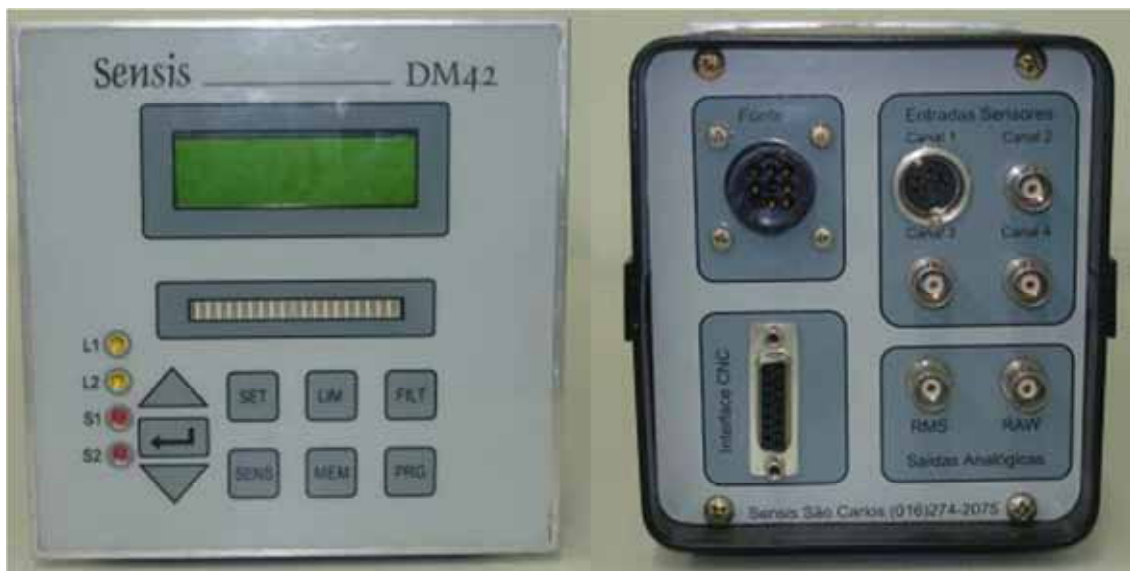
Figura 17 - Unidade de Tratamento do sinal de Emissão acústica
