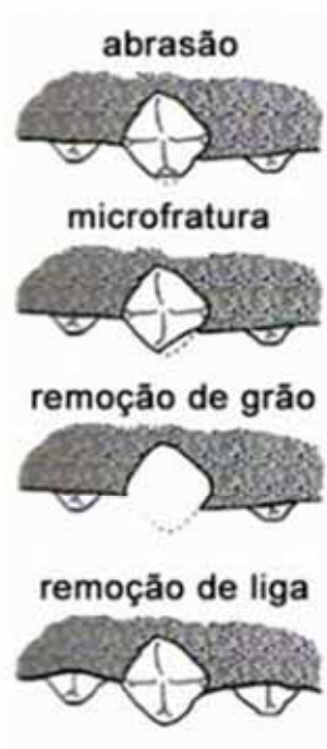
Figura 5 - Alterações ocorridas na micro topografia durante a retificação (Tönshoff et al. 1999).
