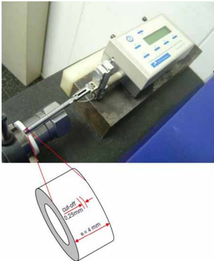
Figura 18 - Operação de medição de rugosidade
