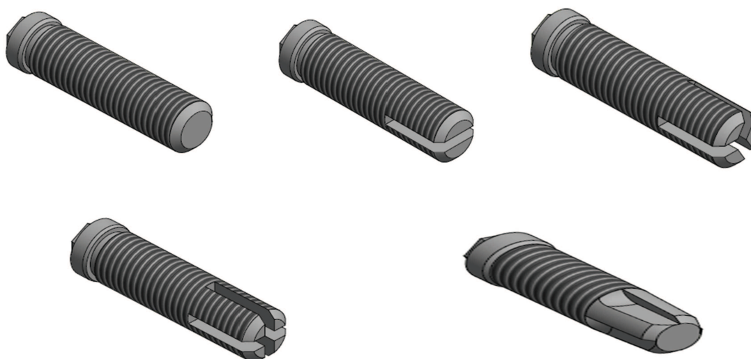
Figura 1. Da esquerda para a direita. Implante A (sem entalhe), Implante B (ápice dividido em duas partes); Implante C (ápice tri-partido); Implante D (ápice quadri-partido) e um quinto grupo Implante (TiEx - controle) Ttitamax Ti Ex (Neodent, Curitiba, Paraná, Brasil).
