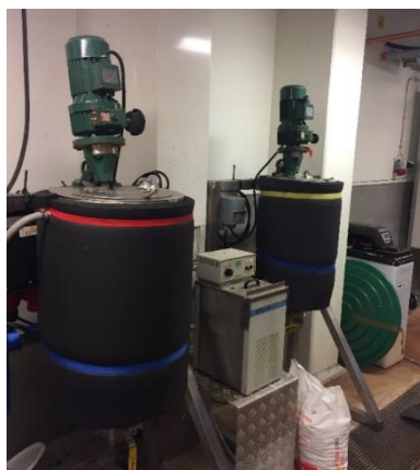
Figura 6. Reator de tambor rotativo de capacidade de 30L para hidrólise enzimática Departamento de Engenharia Química, Universidade de Lund (Fonte pessoal).
