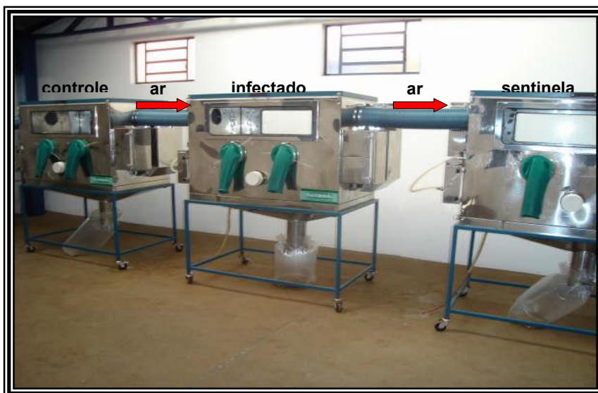
Figura 4 – Montagem das câmaras de isolamento para estudo da transmissão aérea. Observar a disposição linear permitindo conexões e passagem apenas de ar entre os três ambientes.
