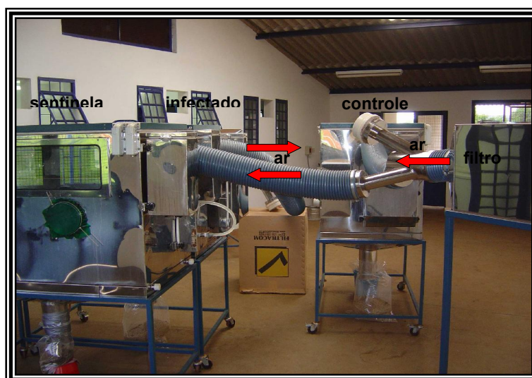
Figura 2 – Montagem dos isoladores para estudo da transmissão naso-nasal. Observar a disposição entre o isolador infectado e sentinela e o fluxo de ar entre eles.
