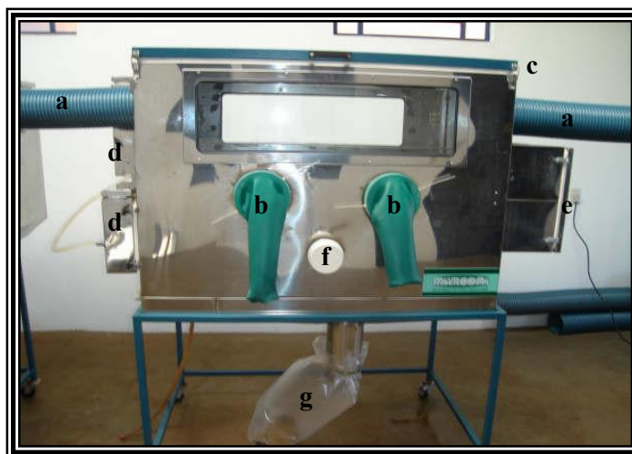
Figura 1 – Câmara de isolamento de suínos: a) tubos de conexão (acima, à direita e à esquerda); b) luvas (em azul), usadas para manejo interno dos animais; c) depósito de ração; d) depósito de água; e) câmara de fumigação (utilizada para introdução e retirada de materiais no sistema); f) fenda de conexão; g) saco de dejetos.
