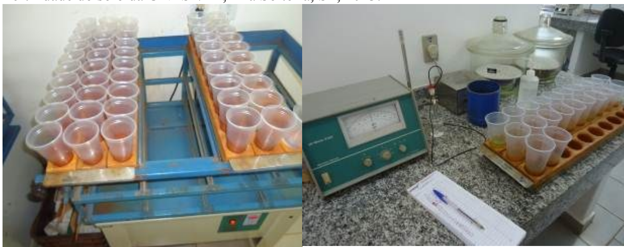
Figura 26- Detalhe da agitação das amostras químicas do solo para determinação do pH (esquerda) e determinando o valor do pH em peagâmetro (direita), no Laboratório de Fertilidade do solo da UNESP/FE, Ilha Solteira, SP, 2013.
