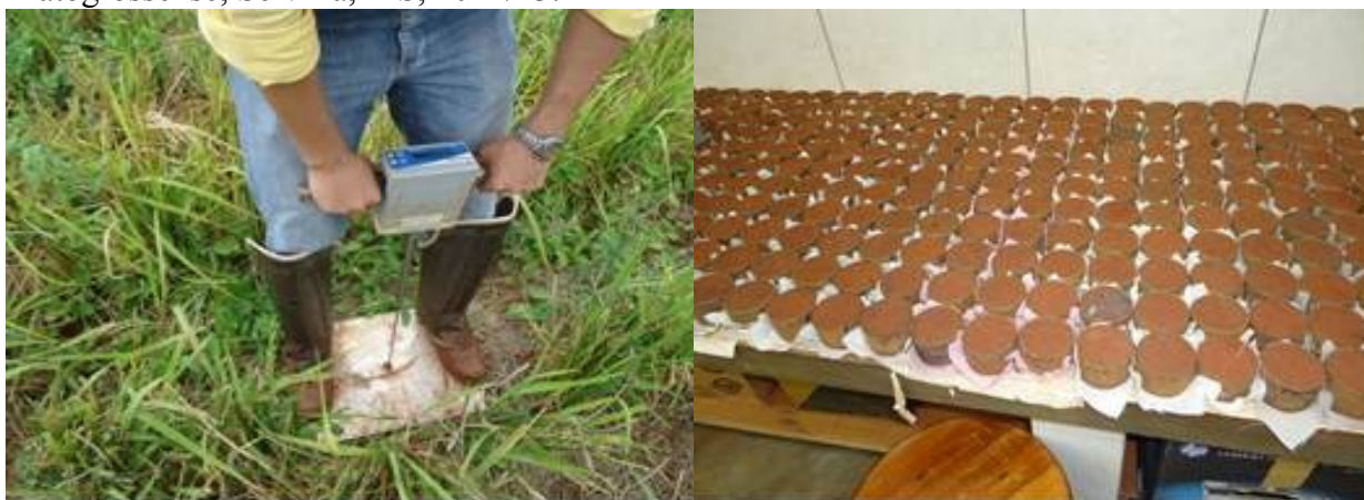
Figura 22- Avaliação de resistência do solo à penetração após a colheita do arroz (esquerda) e amostras de física do solo no laboratório de física do solo (direita), no Cerrado Sul-Matogrossense, Selvíria, MS, 2012/13.
