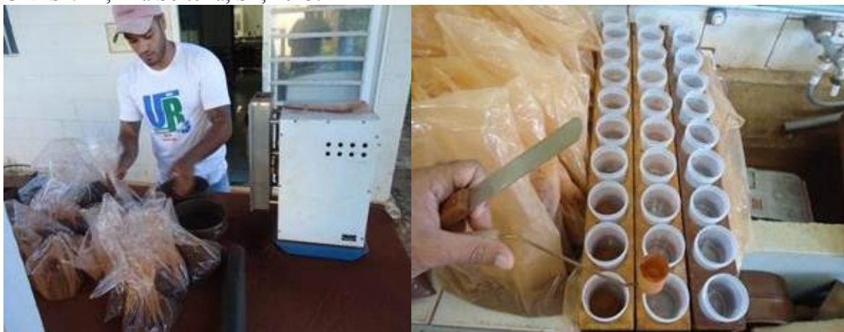
Figura 25- Detalhe da preparação e passagem na peneira de 2 mm das amostras químicas do solo (esquerda) e cachimbando as amostras (direita), no Laboratório de Fertilidade do solo da UNESP/FE, Ilha Solteira, SP, 2013.
