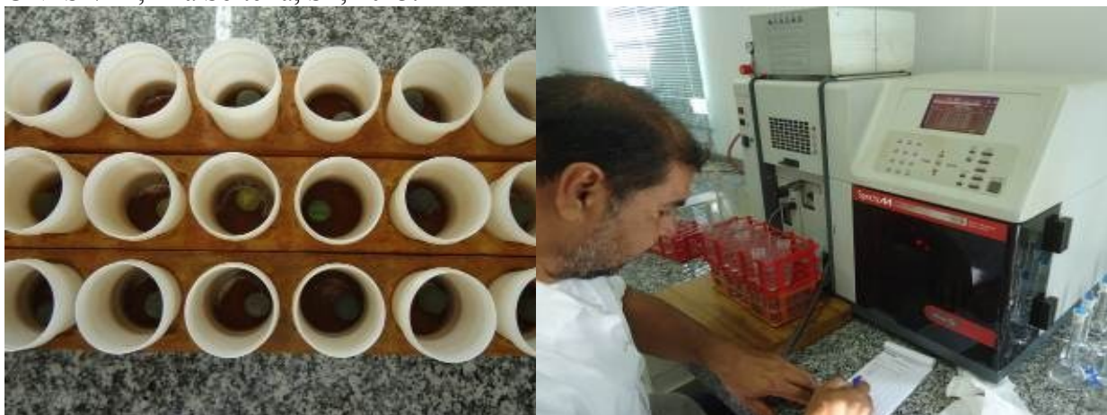
Figura 27- Detalhe da preparação e desestruturação das partículas do solo para determinação do fósforo e cátions trocáveis pelo método da resina trocadora de íons (esquerda) e realizando as leituras no espectrômetro de chama (direita), no Laboratório de Fertilidade do solo da UNESP/FE, Ilha Solteira, SP, 2013.
