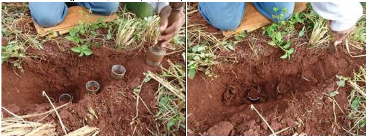
Figura 20- Detalhe da coleta de amostras indeformadas do solo após a colheita do arroz (esquerda) e retirando-se os anéis volumétricos nas camadas supracitadas (direita), no Cerrado Sul-Matogrossense, Selvíria, MS, 2012/13.
