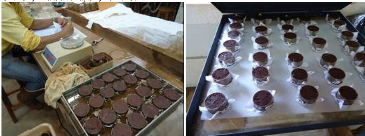
Figura 23- Pesagem de amostras do solo em balança analítica após saturação em água durante 24 horas (esquerda) e detalhe das amostras de física do solo na mesa de tensão para determinação de macroporosidade do solo (direita), no Laboratório de Física do solo na UNESP, Ilha Solteira, SP, 2012/13.
