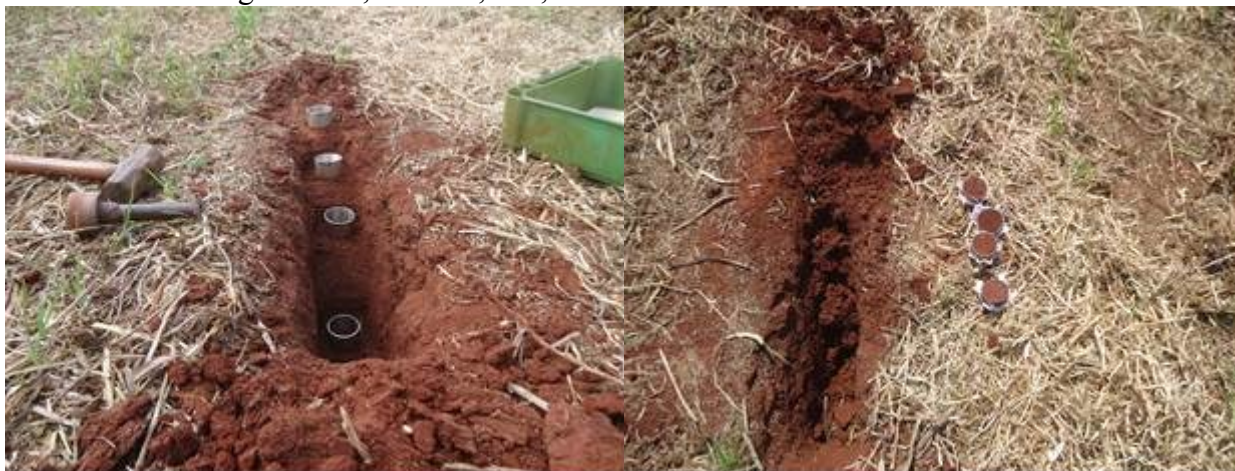
Figura 38- Coleta de amostras indeformadas do solo nas diferentes camadas, após cultivo do feijão (esquerda) e amostras coletadas e devidamente identificadas em campo (direita), no Cerrado Sul-Matogrossense, Selvíria, MS, Safra 2014.
