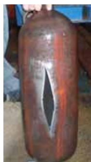
Foto 56 – corpo de prova 02 rompido.
