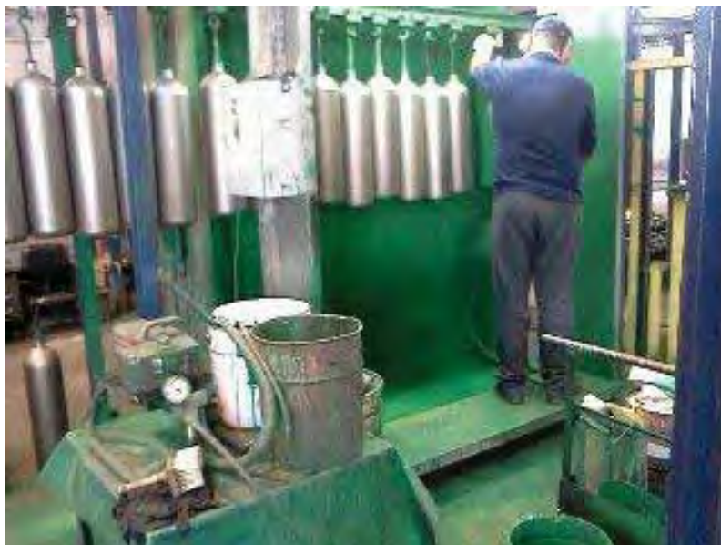
Figura 22 – Processo de pintura (MAT SA, 2011).
