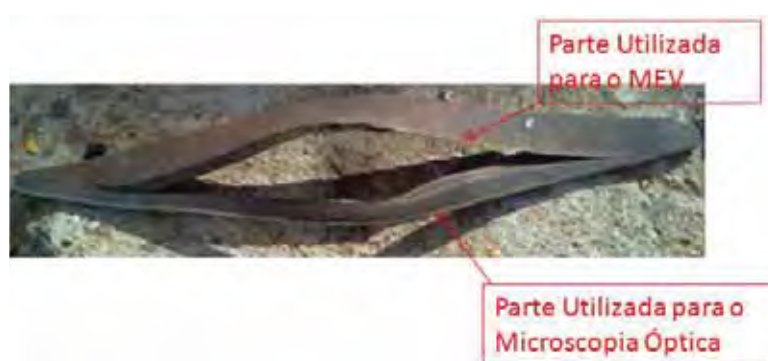
Figura 52 - Identificação das áreas de estudo no corpo de prova.
