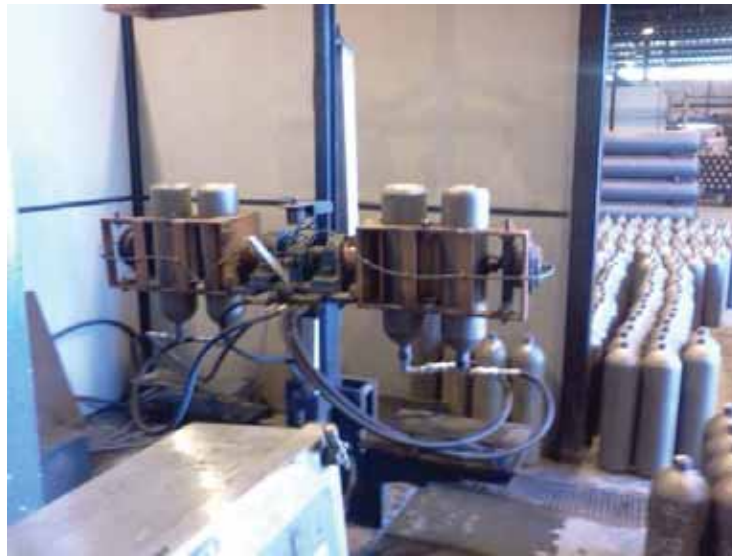
Figura 20 - Teste de vazamento nos cilindros (MAT SA, 2011).
