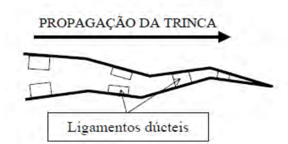
Figura 31. Ilustração esquemática da propagação da trinca por clivagem na região de transição dúctil- frágil (EFFTING, 2004).
