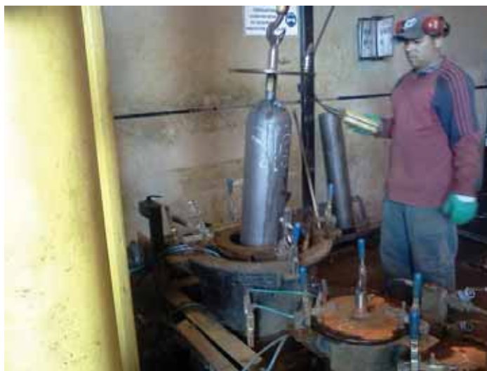
Figura 21 – Teste hidrostático – Camisa D'água (MAT SA, 2011).
