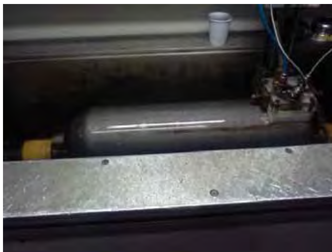
Figura 19 – Inspeção em todo corpo do cilindro para detecção de defeitos (MAT SA, 2011).
