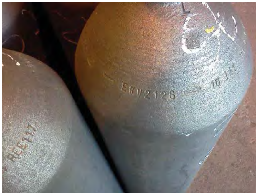
Figura 15 – Marcações nos cilindros (MAT SA, 2011).
