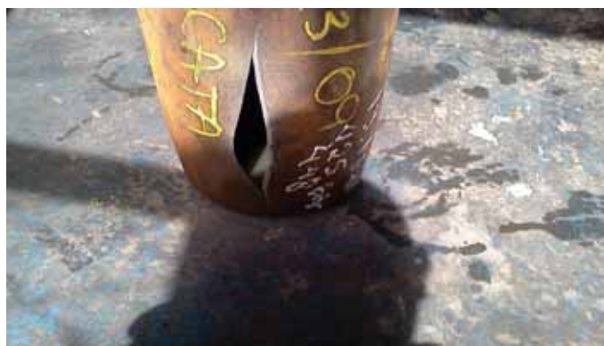
Foto 57 – corpo de prova 01 rompido.
