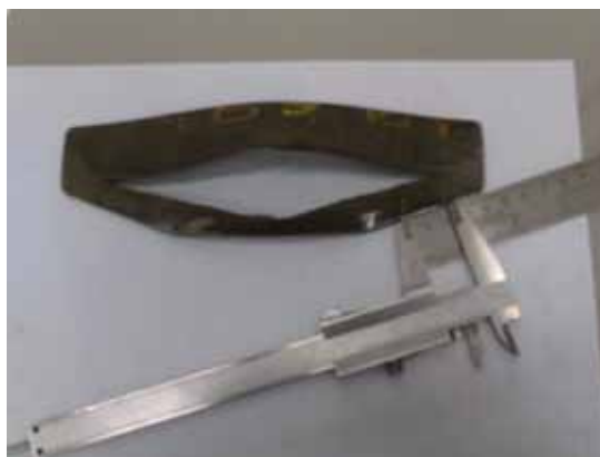
Figura 53 – Corpo de prova após seccionamento – identificação do tamanho da amostra.
