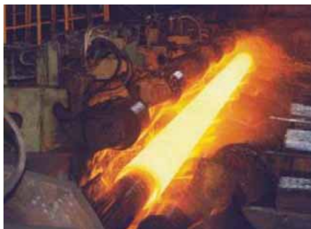
Figura 05 – Laminação automática – Mannesmann (MANNESMANN, 2011).
