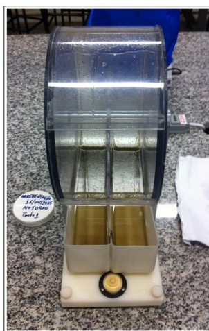
Figura 10: Fracionamento das amostras devido à alta abundância de organismos zooplancônicos capturados.
