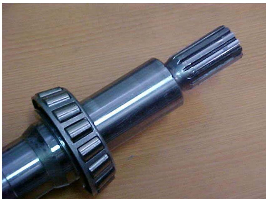
Figura 4.7 – Anel interno do rolamento 30309 montado no eixo
