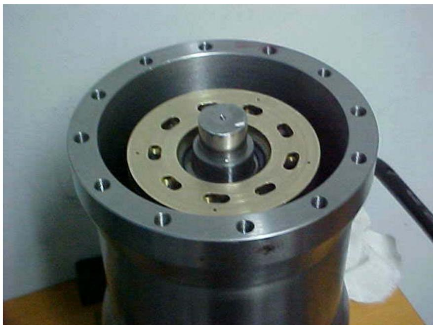
Figura 4.24 – Anel de desgaste e corpo central, montados.
