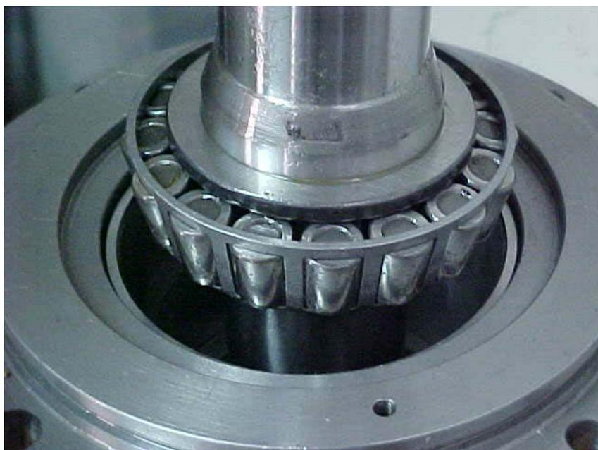
Figura 4.10 - Montagem do anel interno e eixo no anel externo
