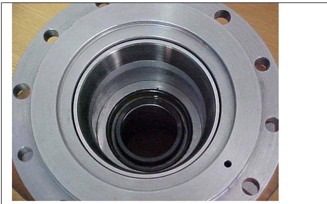
Figura 4.9 - Anel externo na posição final de montagem.
