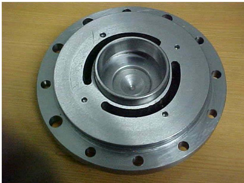
Figura 4.25 – Montagem do anel externo do rolamento 30306
