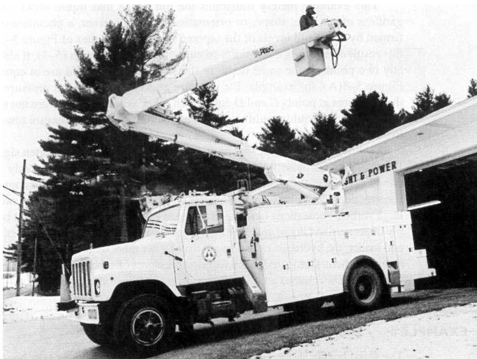
Figura 2.2 - Guincho para manutenção elétrica.
