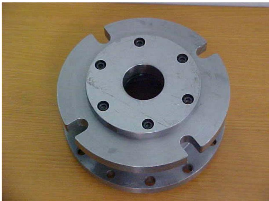
Figura 4.6 – Flange guia montado no flange SAE C.
