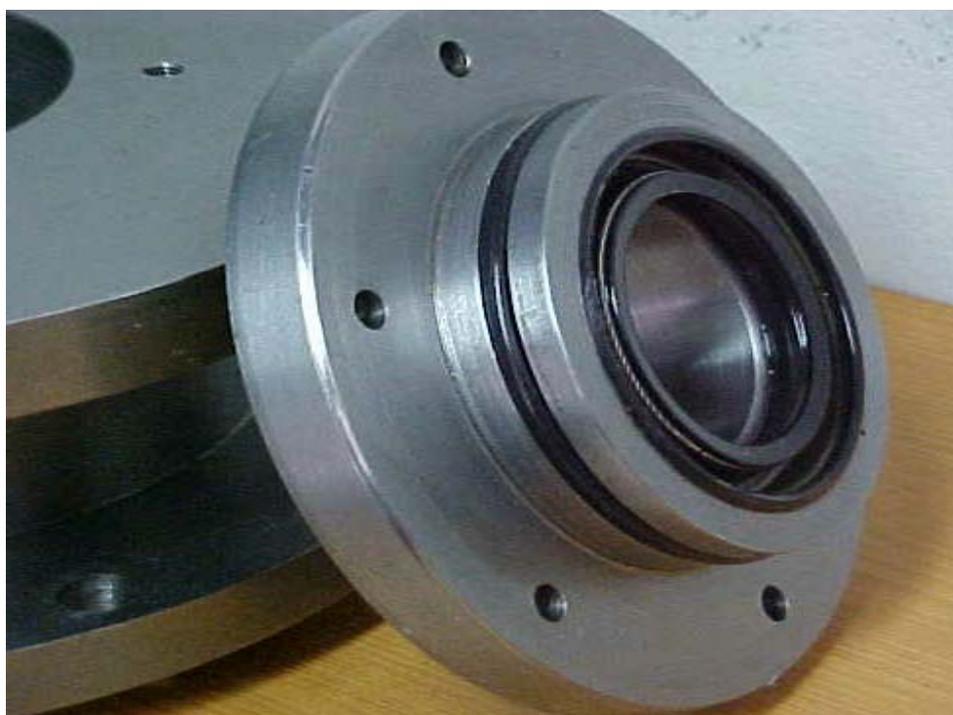
Figura 4.4 – Retentor e anel O' ring montados.
