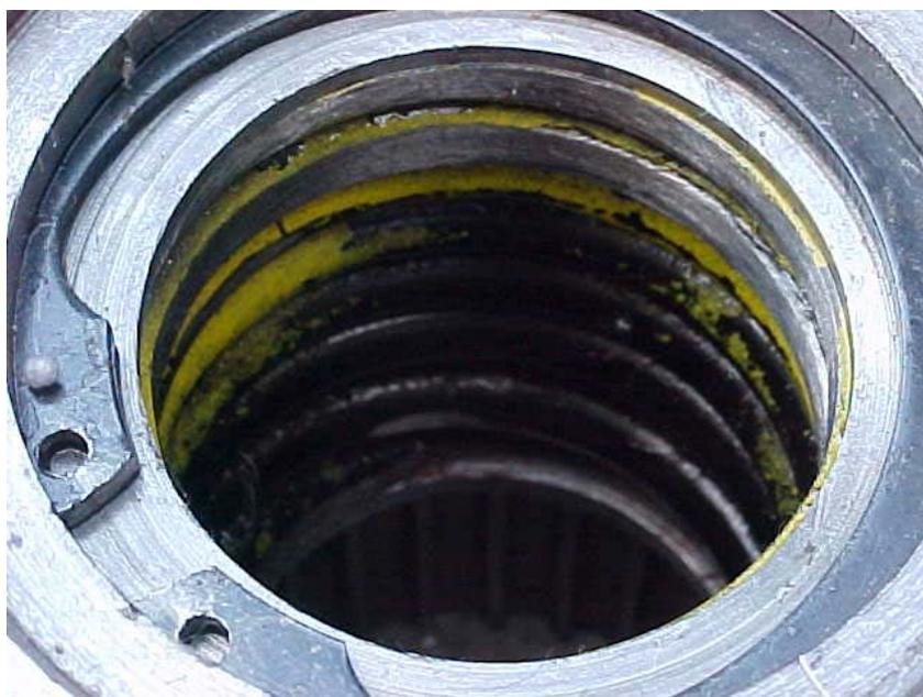
Figura 4.18 – Detalhe da mola montada no tambor e anel elástico.
