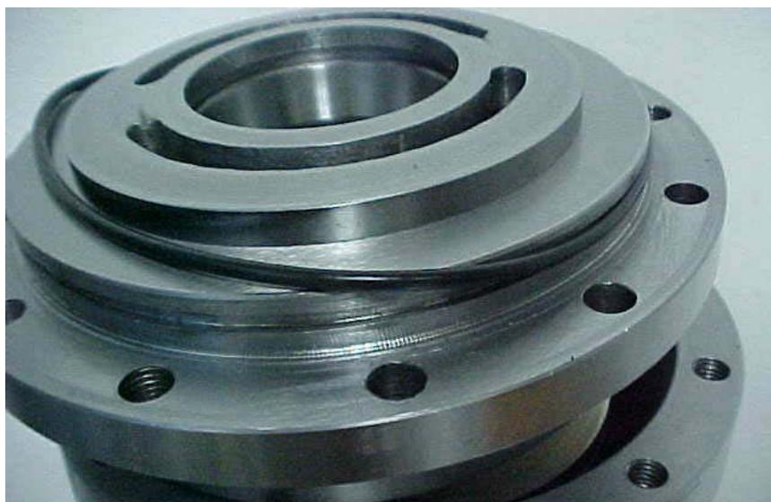
Figura 4.30 – Anel O' ring sendo montado no flange entrada/saída de óleo
