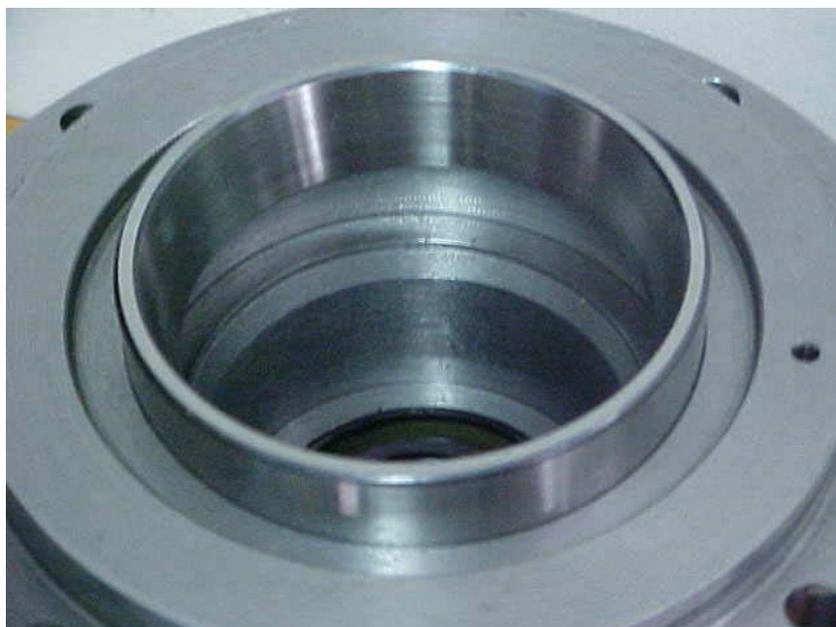
Figura 4.8 – Montagem do anel externo do rolamento 30309
