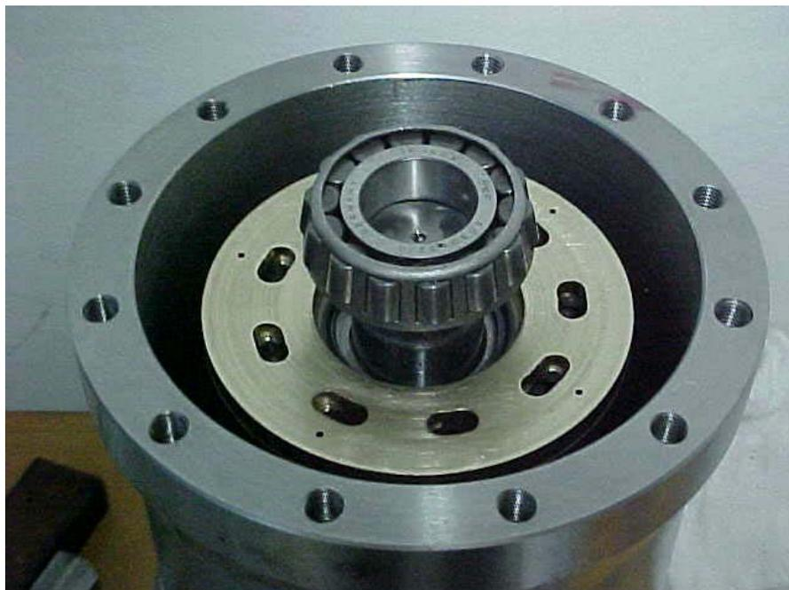
Figura 4.29 – Anel interno do rolamento 30306 montado no eixo
