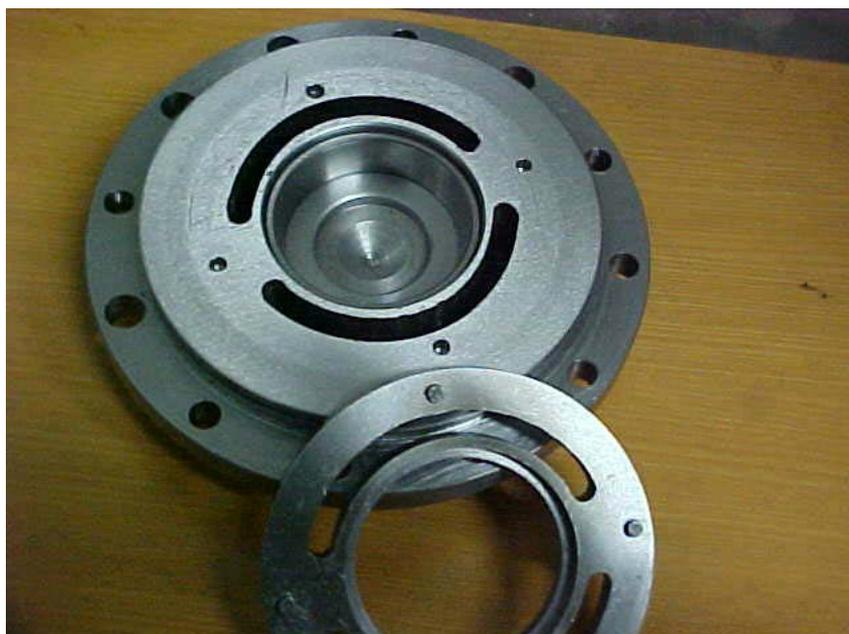
Figura 4.27 – Montagem do anel de desgaste de aço no flange
