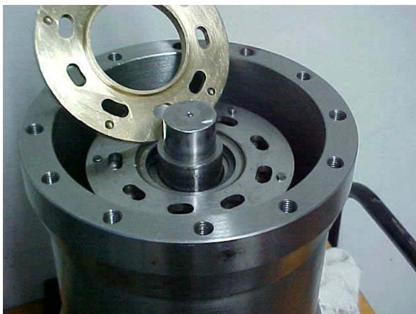
Figura 4.23 – Montagem do anel de desgaste de bronze no tambor.
