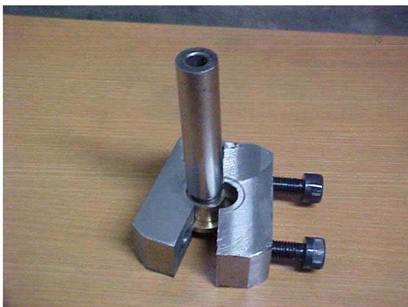
Figura 4.15 – Ferramenta especial para a montagem do pistão/ mancal.
