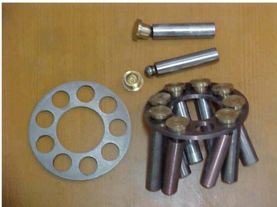
Figura 4.17 – Placa de retenção e pistões/mancais.
