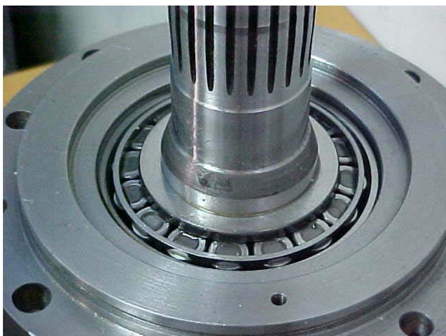
Figura 4.11 – Flange, rolamento 30309 e eixo montados.
