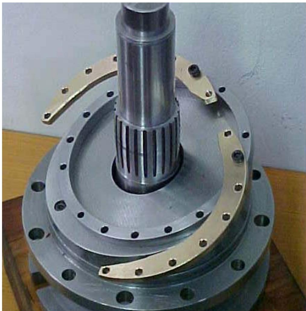
Figura 4.16 – Mancal da placa de retenção e seu suporte
