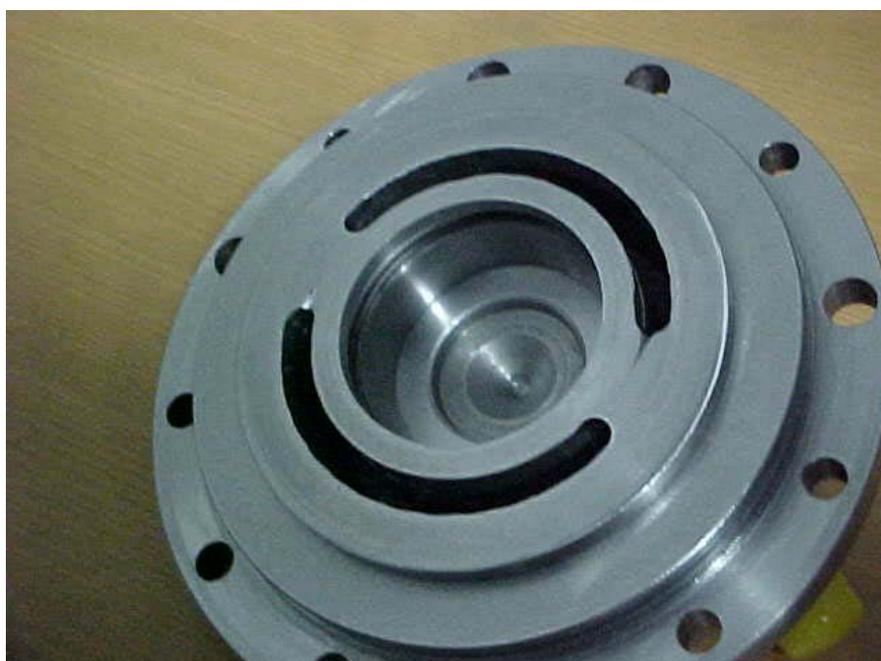
Figura 4.28 – Anel de desgaste de aço montado.
