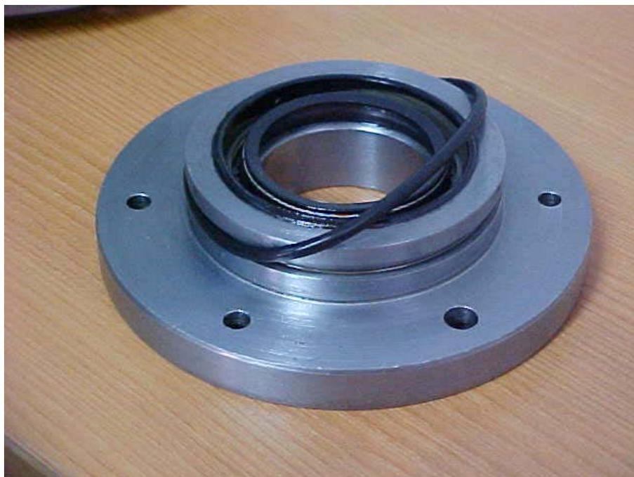
Figura 4.3 – Montagem do anel O' ring no flange guia
