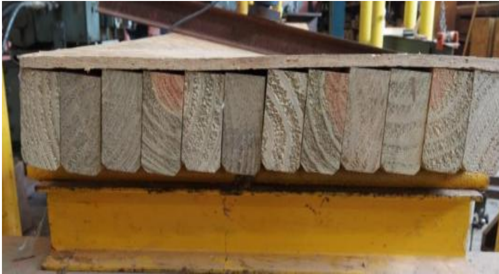
Figura 50 – Painel de MLP com maior número de lamelas na seção submetido a flexão.
