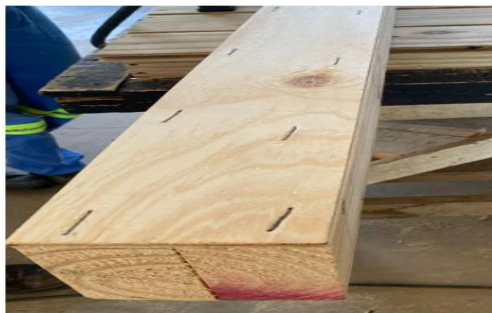
Figura 36 – Viga de MLP com chapa compensada fixada na parte superior.
