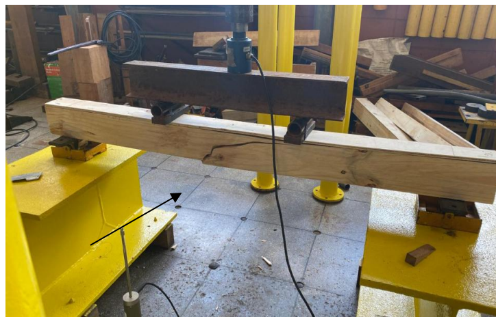
Figura 47 – Ruptura por tração inferior do CP6 no ensaio de flexão.
