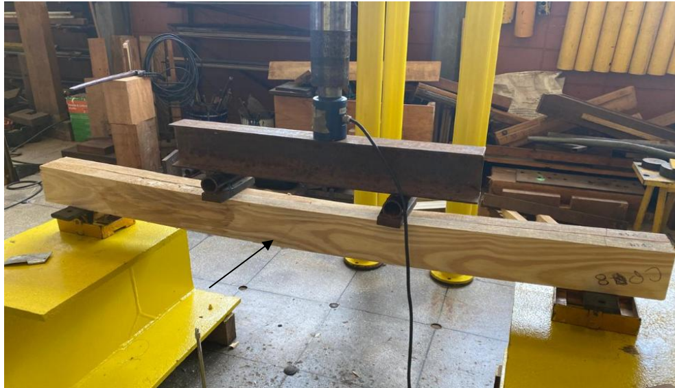
Figura 49 – Modo de ruptura por tração inferior no CP8 no ensaio de flexão.
