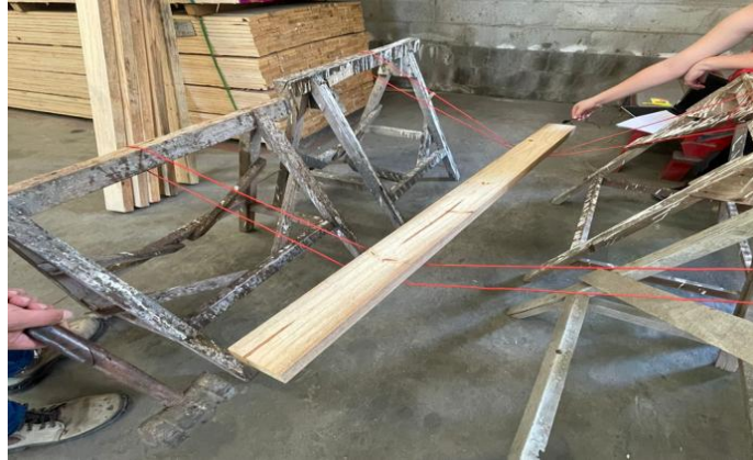
Figura 32 – Ensaio pelo método de excitação por impulso para determinação do Módulo de elasticidade.
