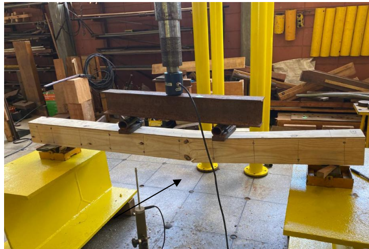
Figura 46 – Ruptura no nó inferior do CP2 por tração no ensaio de flexão.
