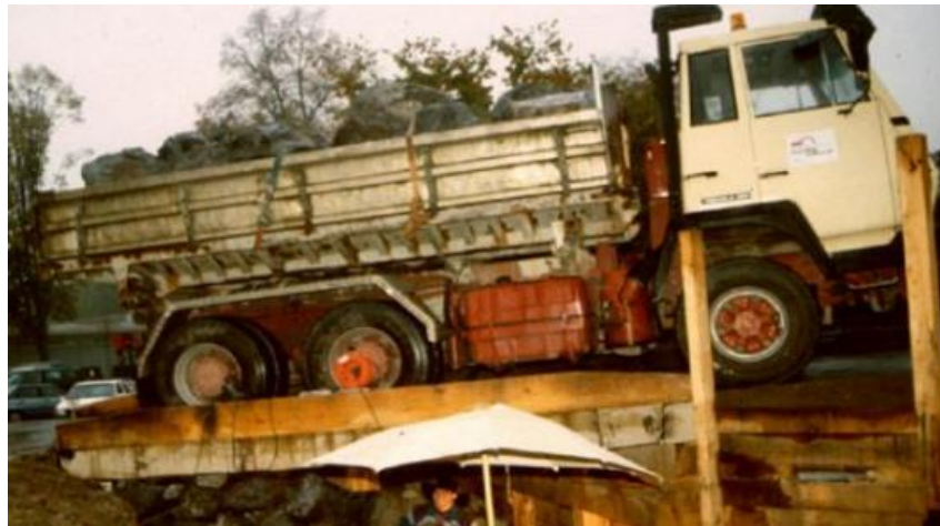
Figura 11– Prova de carga do tabuleiro de ponte.
