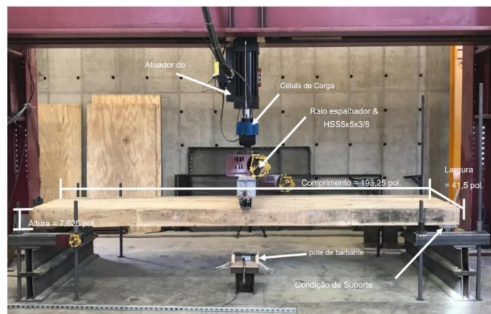
Figura 16 – Painel de MLP no ensaio de flexão.
