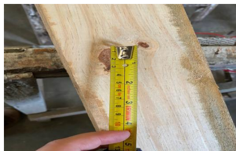
Figura 31 – Lamela avaliada na classificação visual.
