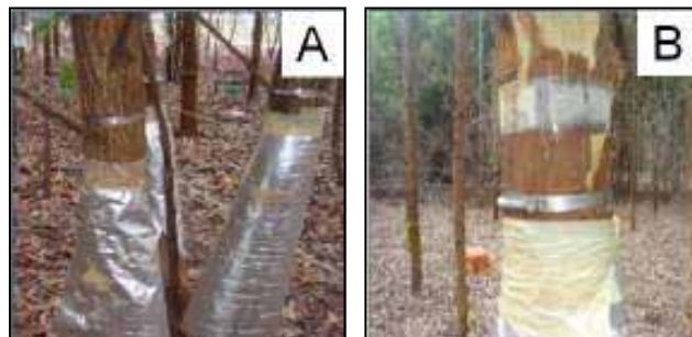
Figura 13. Faixas dendrométricas instaladas na área experimental: (A) árvores de Acacia mangium equipadas com faixas dendrométricas; (B) árvores de Eucalyptus grandis equipadas com faixas dendrométricas.
