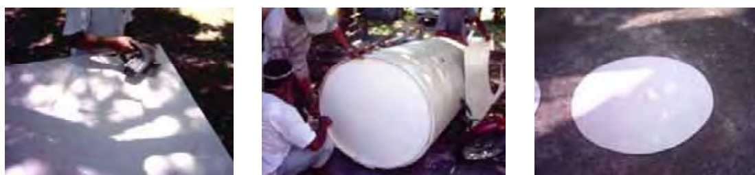
Figura 5.8 – Corte das chapas de PVC de 2 mm de espessura, no formato da tampa do gasômetro
