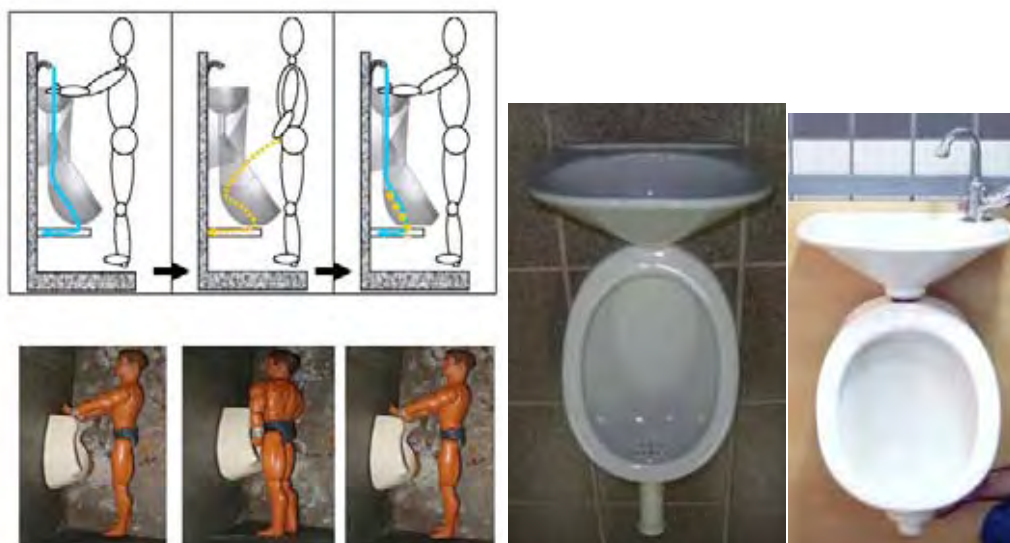
Figura 3.9 – Desenho esquemático e maquete simulando a utilização do ME e vista da versão monobloco e da versão acoplável em mictórios já instalados.
