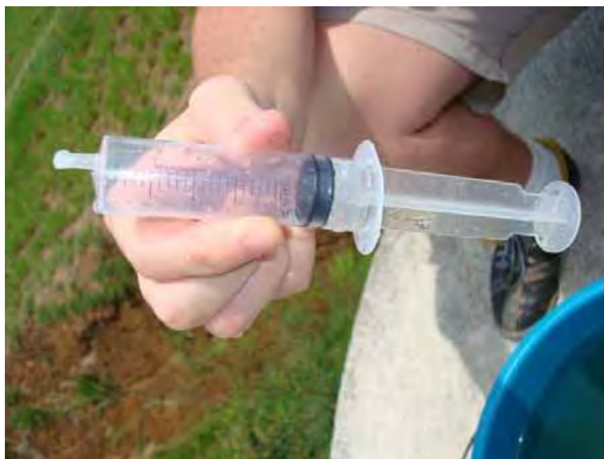
Figura 7.7 – Foto ilustrativa da seringa cheia de biogás e lacrada por meio de elastômero termoplástico de uso em ortodontia
