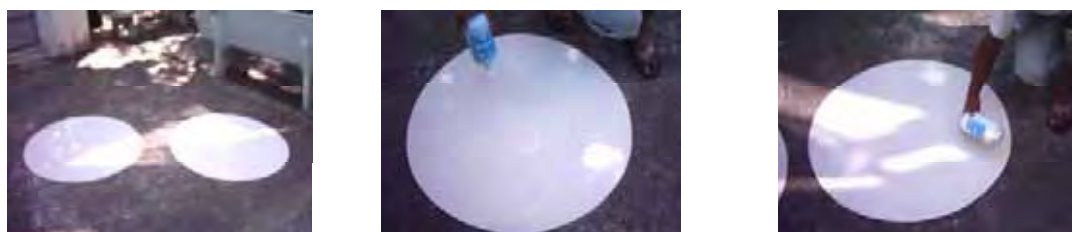
Figura 5.9 – (A) Colagem das duas chapas para formar a tampa do gasômetro, (B) aplicação de solução limpadora de PVC e (C) aplicação do adesivo de PVC
