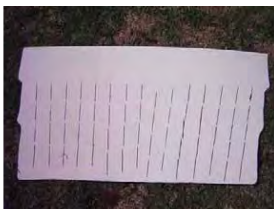
Figura 4.8 – Grade em PVC confeccionada a partir de uma chapa de 3 mm em PVC
