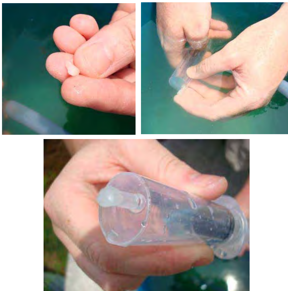
Figura 7.8 – Foto ilustrativa sequencial da selagem da seringa cheia de biogás por meio de elastômero termoplástico de uso em ortodontia
