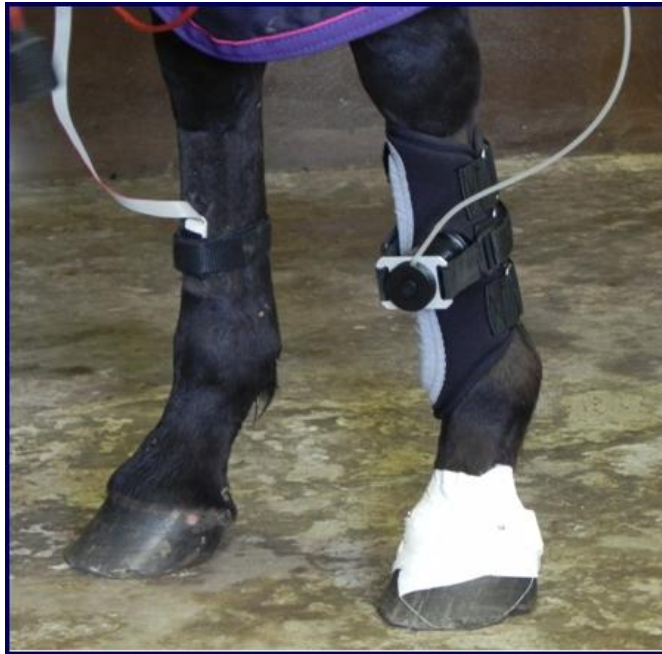
Figura 2 - Equipamentos para estímulo nociceptivo térmico (metacarpo direito) e mecânico (metacarpo esquerdo) posicionados em um cavalo.
