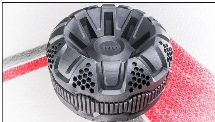
Figura 22 - Ferramenta construída com manufatura aditiva com fibra de carbono.
