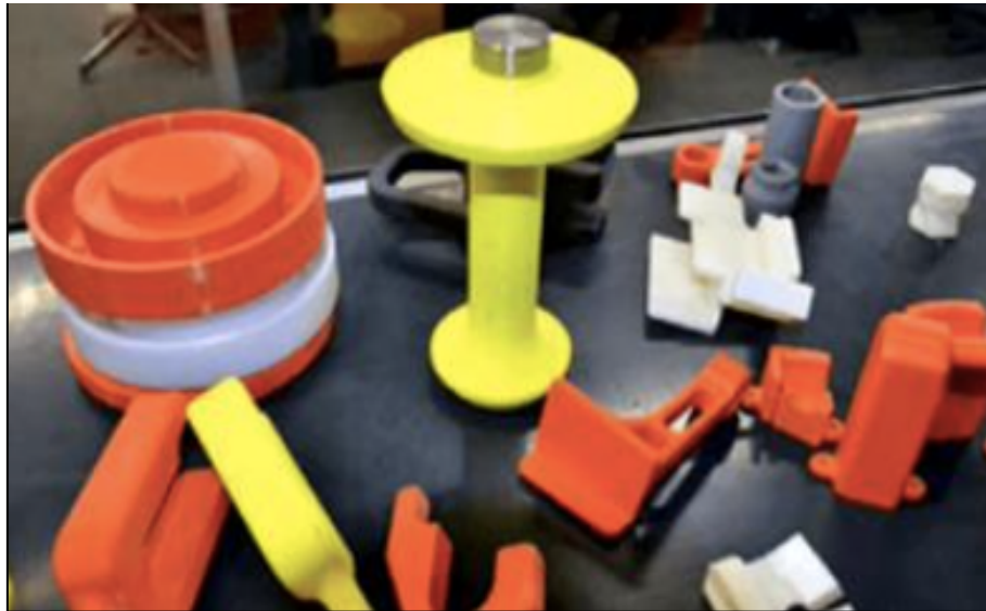
Figura 21 - Gabaritos impressos com manufatura aditiva utilizados em empresas automotivas.
