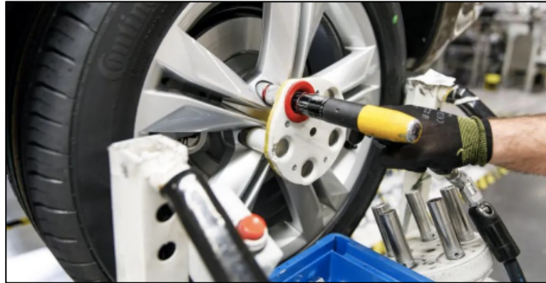
Figura 23 - Peça impressa em manufatura aditiva para proteção de roda.
