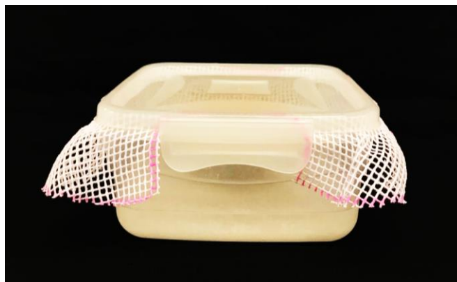
Figura 4 - Caixa hermética contendo solução saturada de NaCl para avaliação da longevidade de sementes.
