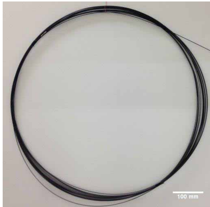
Figura 12 - Pultrudado de fibras de carbono com resina fenol formaldeído
