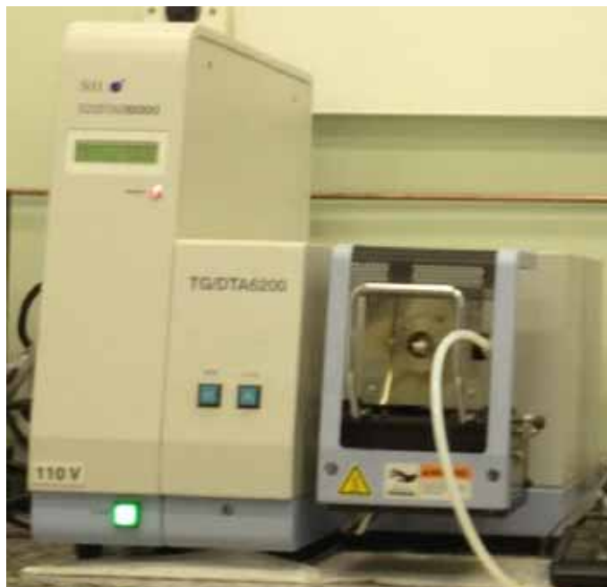
Figura 15 - Equipamento de TGA da SII Nanotechnology
