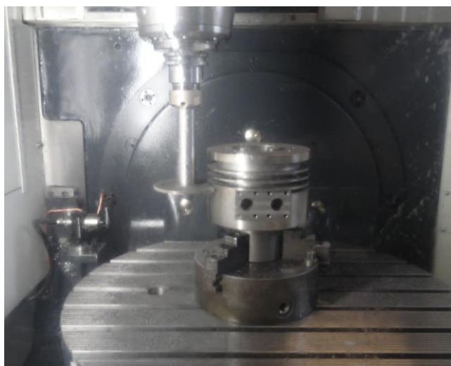
Figura 41 - Usinagem das aletas de refrigeração.
