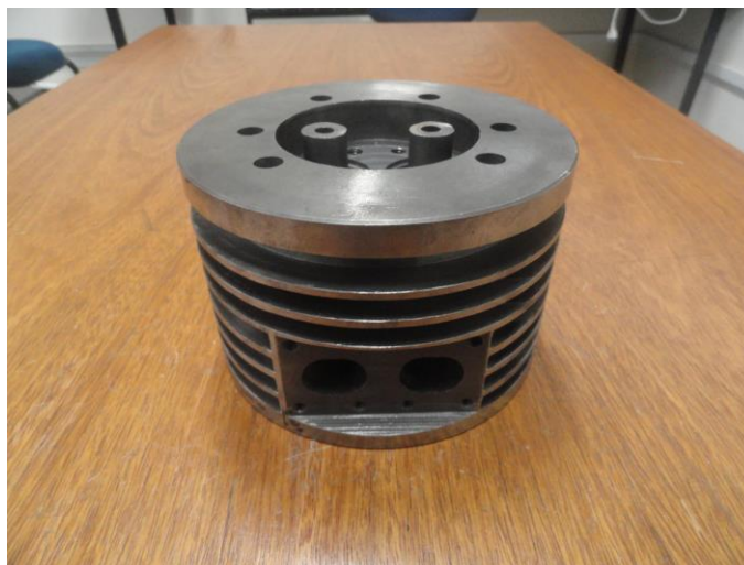
Figura 56 – Flange dos dutos de admissão e escape, aletas de refrigeração.
