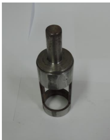
Figura 12 – Ferramenta para colocação da mola da válvula.
