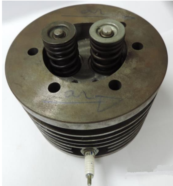
Figura 52 - Vela de ignição rosqueada no cabeçote.
