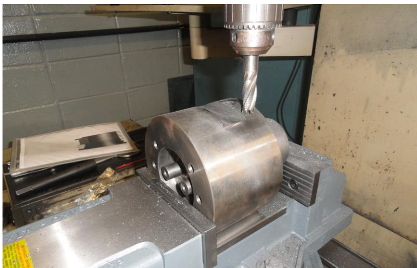
Figura 37 - Usinagem do flange para os dutos de admissão e escape.
