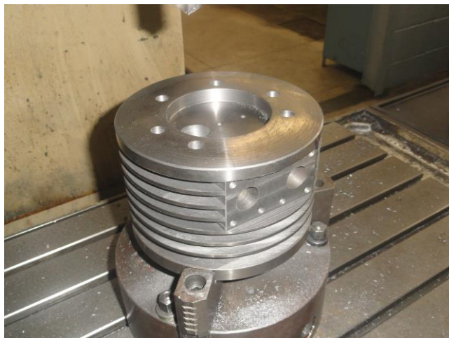
Figura 43 - Usinagem da câmara de combustão.
