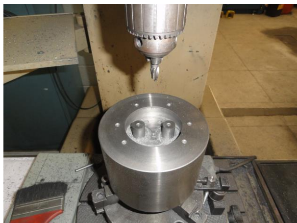
Figura 34 - Parte superior do cabeçote usinada.
