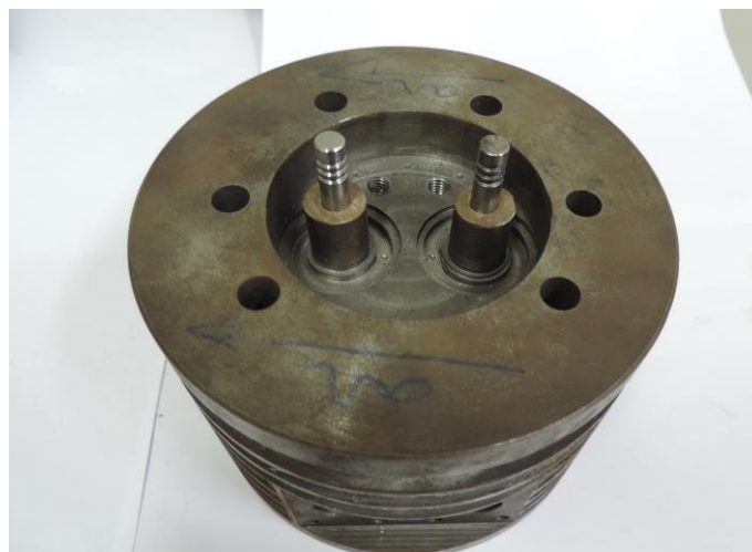
Figura 48 - Hastes das válvulas inseridas nos respectivos furos guias.
