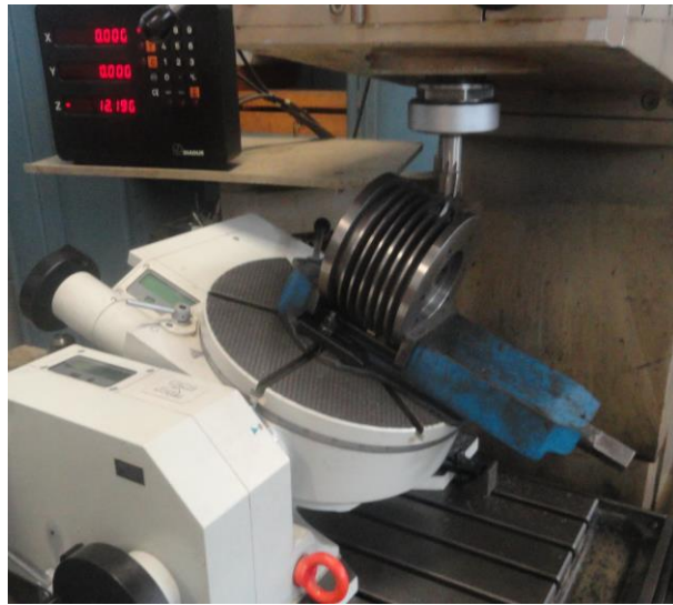
Figura 45 - Usinagem do furo da vela de ignição.
