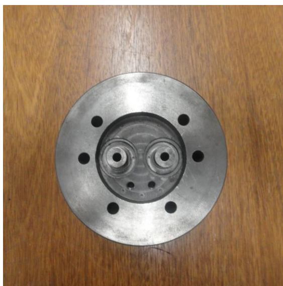
Figura 55 – Guias de válvulas, depósito de óleo do cabeçote, fixação do suporte de balancim.
