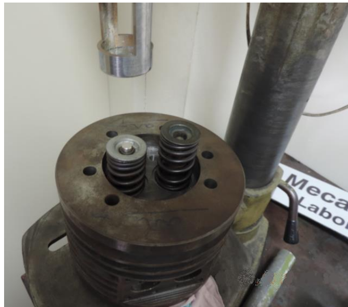
Figura 51 - Válvula de escape e acessórios montados.
