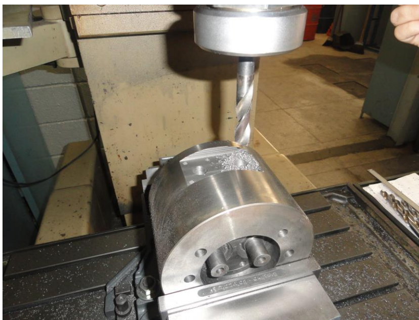
Figura 38 – Usinagem dos furos para admissão e escape.
