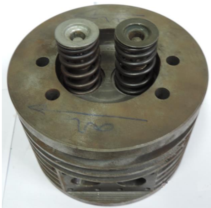
Figura 49 - Posicionamento das molas das válvulas.
