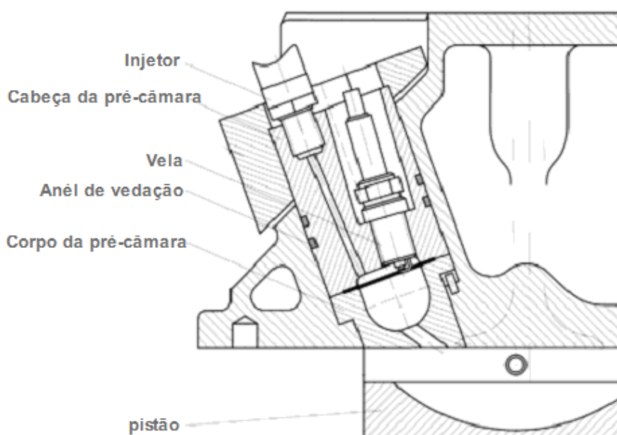
Figura 9 – Pré-câmara de combustão.
