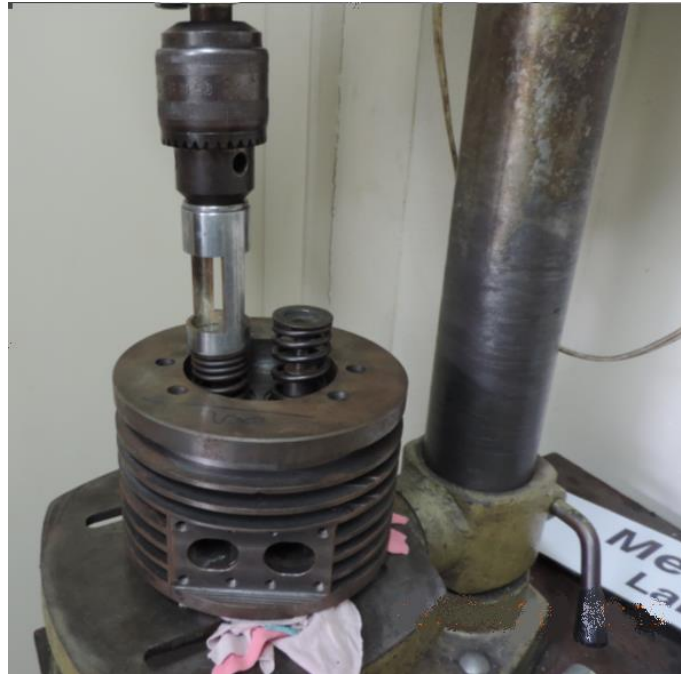
Figura 50 - Ferramenta de montagem na posição comprimindo a mola.
