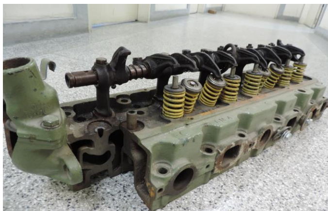
Figura 14 - Cabeçote de um motor Chevrolet 6 cilindros.
