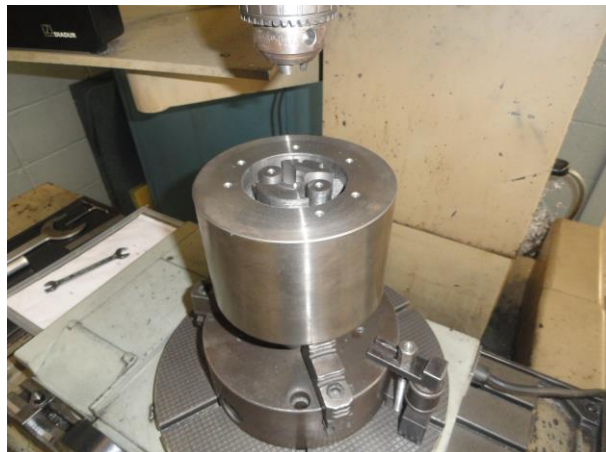
Figura 33 - Usinagem da parte superior do cabeçote.
