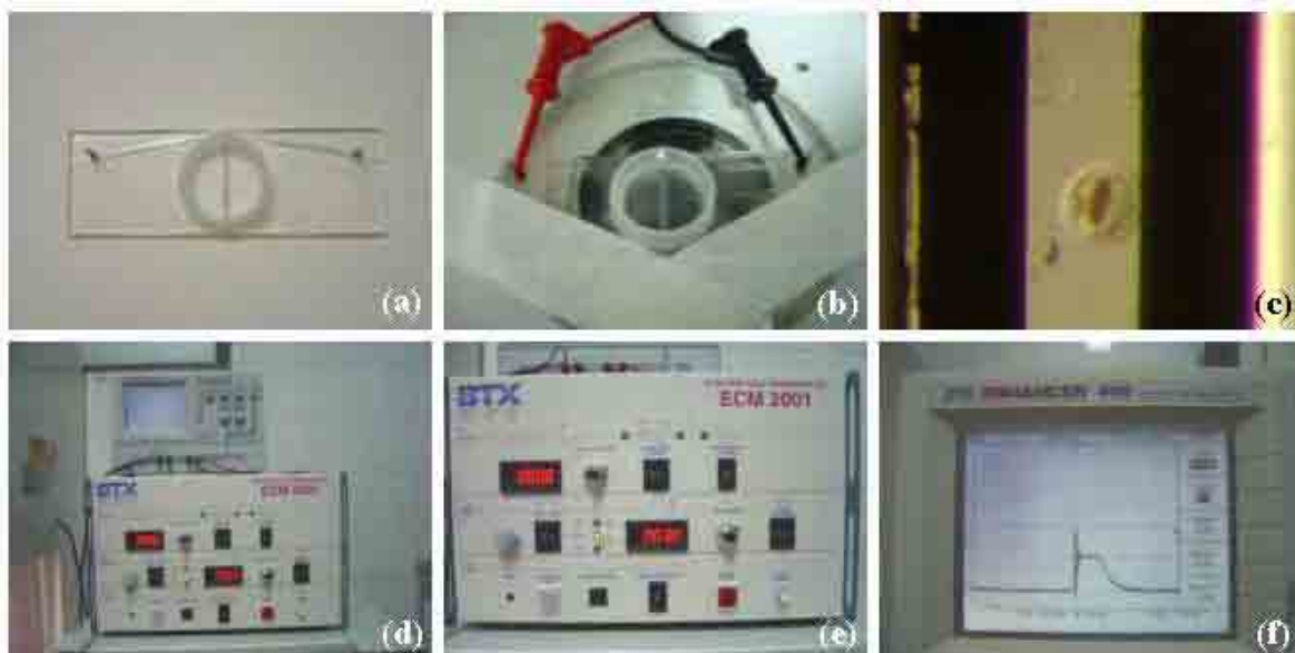
Figura 4. Eletrofusão. (a) Câmara de eletrofusão; (b) ligação do pólo positivo (vermelho) à esquerda e do pólo negativo (preto) à direita da câmara de eletrofusão; (c) posicionamento do zigoto reconstituído na câmara de eletrofusão: pronúcleo transferido à esquerda (próximo ao pólo positivo) e citoplasma à direita (próximo ao pólo negativo); (d) Electrocell Manipulator 2001 BTX; (e) programação do equipamento de eletrofusão; (f) mensuração do pulso aplicado (aproximadamente, 30V) pelo BTX Enhancer.
