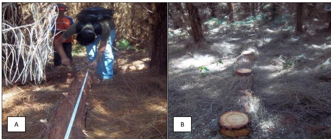
Figura 2. Coleta do material em campo: A – Árvore abatida sendo mensurada e demarcada para retirada dos discos. B – Retirada dos discos nas diferentes alturas.
