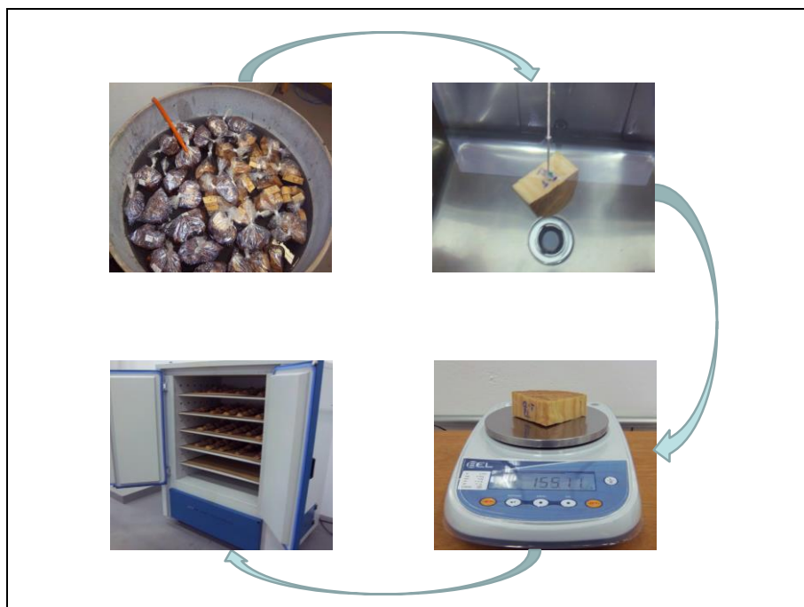
Figura 4. Sequência das atividades realizadas para obtenção da densidade básica das amostras de madeira. Respectivamente, saturação das amostras, medição da massa saturada imersa em água, medição da massa saturada, e secagem a 103 \pm 2 °C.
