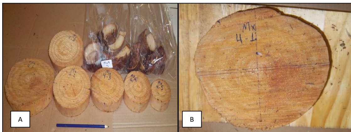
Figura 3. Preparo do material no laboratório: A – Discos e cascas separados. B – Disco demarcado para separação das cunhas.
