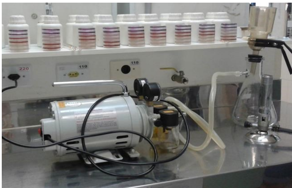
Figura 3. Kit de filtração utilizado para realizar a técnica de membrana filtrante (Micromar, 2023)
