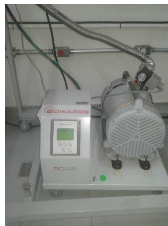
(c) Bomba geradora de vácuo "Edwards"
