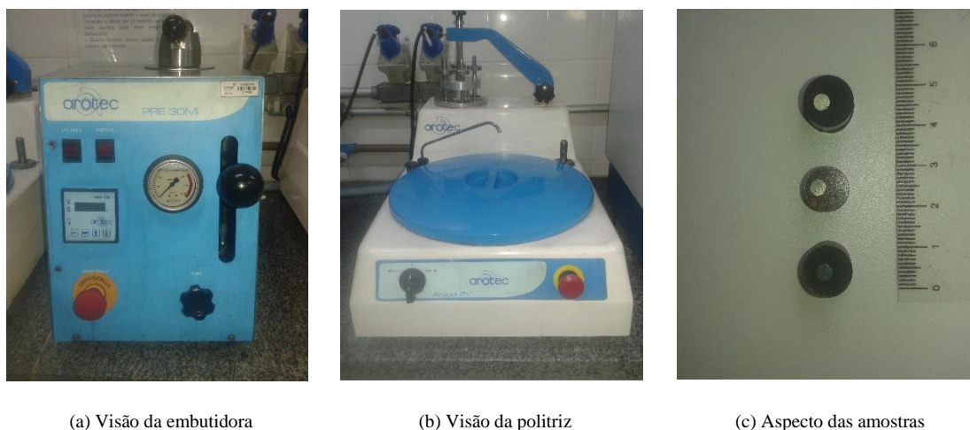
Figura 19. Visão dos equipamentos empregados na obtenção das amostras embutidas.
