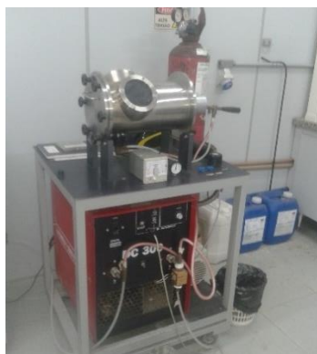
(a) Forno de fusão a arco voltaico com eletrodo não consumível.
