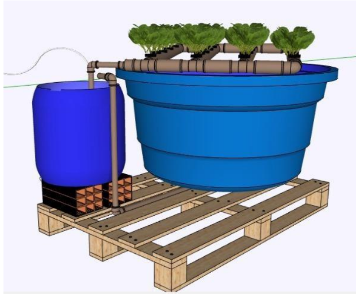
Figura 3. Desenho esquemático da plataforma NFT e o filtro do sistema aquapônico. Por Vinícius Mecca Zabotto.
