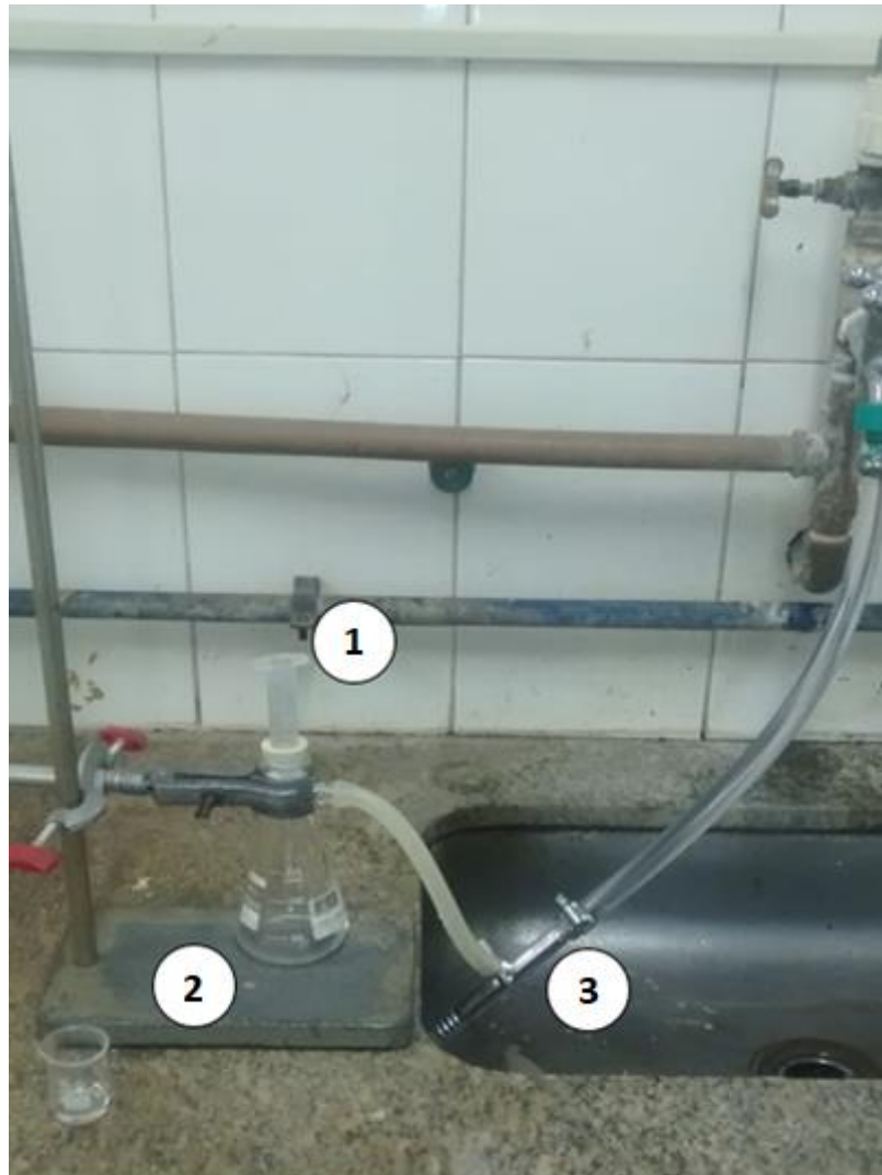
Figura 13 – Esquema de teste de adsorção por coluna
