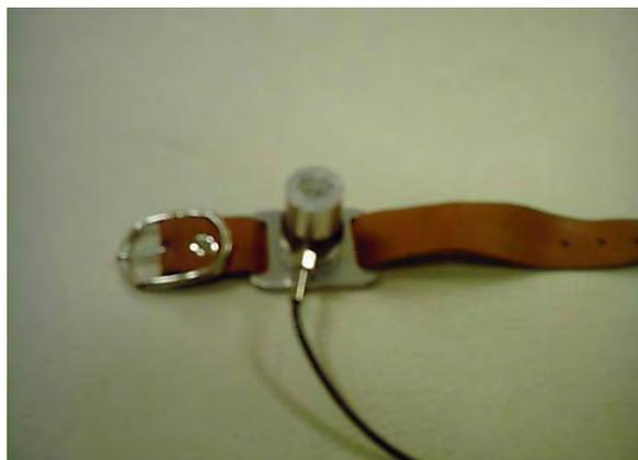
Figura 7 - Acelerômetro KB 35 com adaptador de couro e fivela
