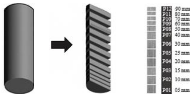
Figura 3.9 – Esquematização do seccionamento de amostras para análise microestrutural das ligas Al-Cu-Mg e Al-Cu-Mg-Ni.
