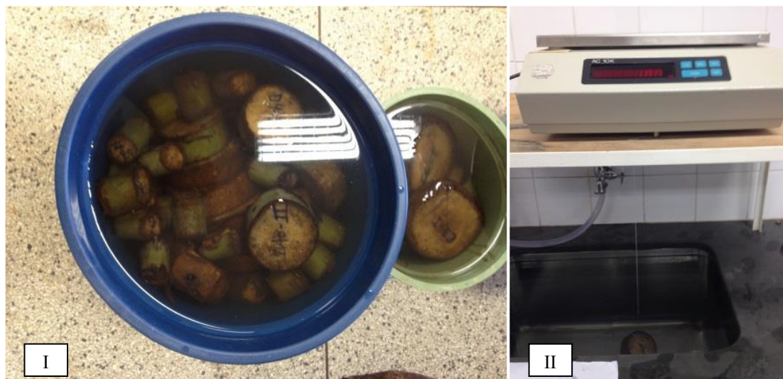
Figura 21. Densidade básica dos discos. I – Discos submersos para saturação; II – Esquema da balança hidrostática.
