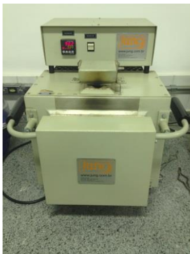
Figura 11. Forno mufla utilizado na análise imediata.
