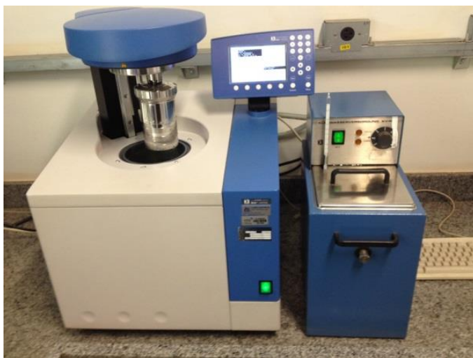
Figura 17. Calorímetro utilizado para determinação do PCS.
