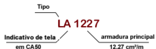
Fig. 15 – Tela de aço CA-50 Fonte: Site IBTS
