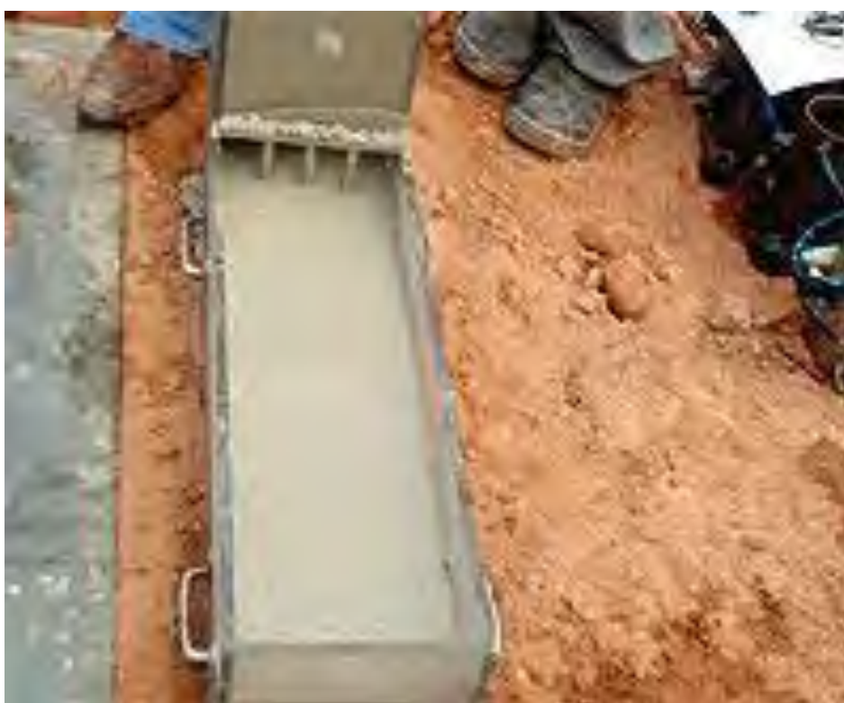
Fig. 24 – Medição de fluidez do concreto Fonte: Revista Técnica (edição 147, fevereiro de 2009)
