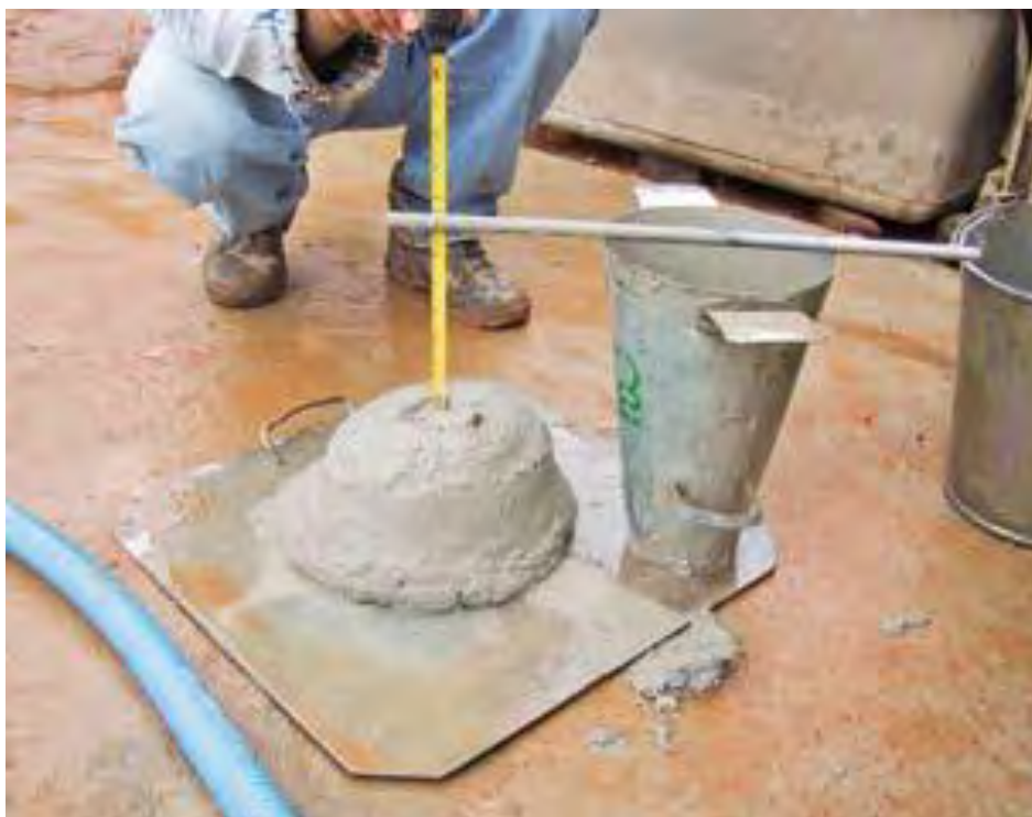
Fig.23 – Slump test Fonte: Coletânea Ativos Paredes de Concreto
