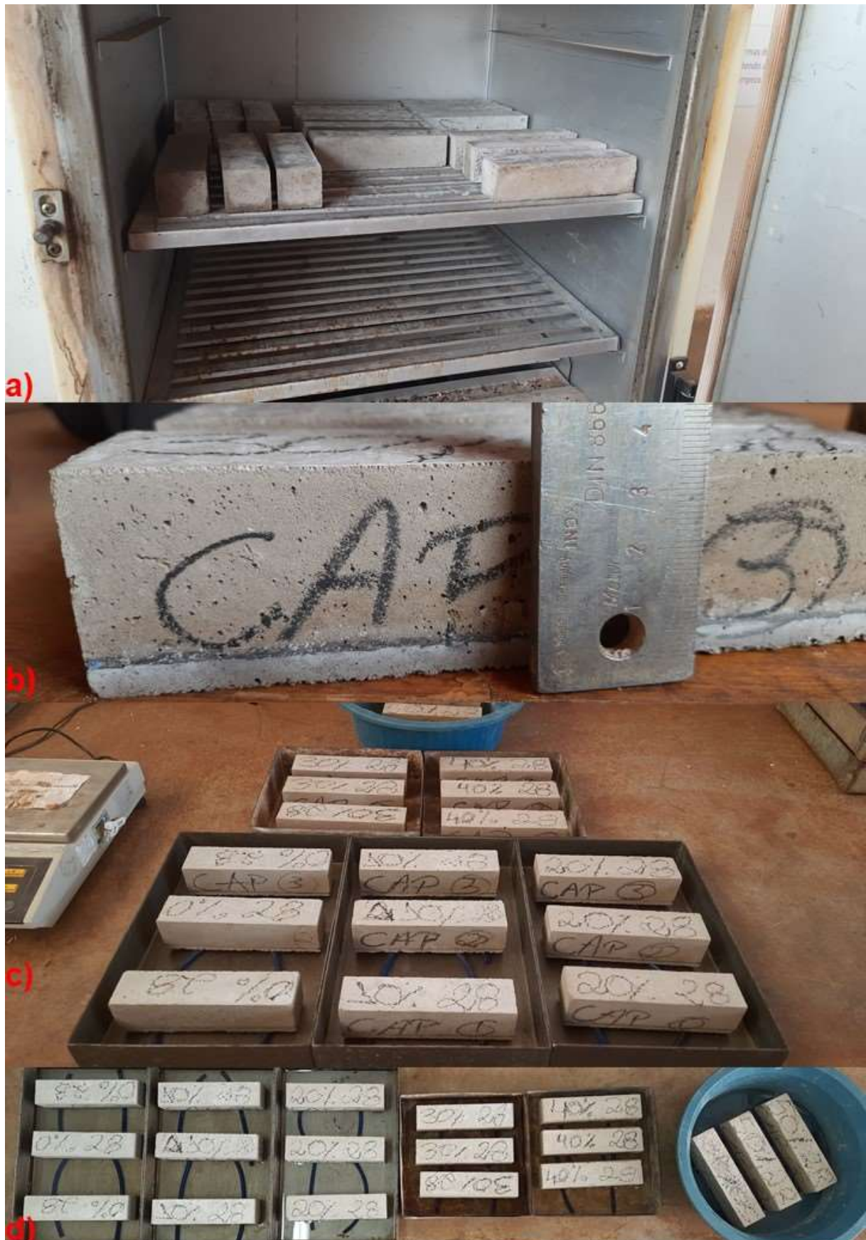
Figura 24 - Corpos de prova em estufas 105 °C
