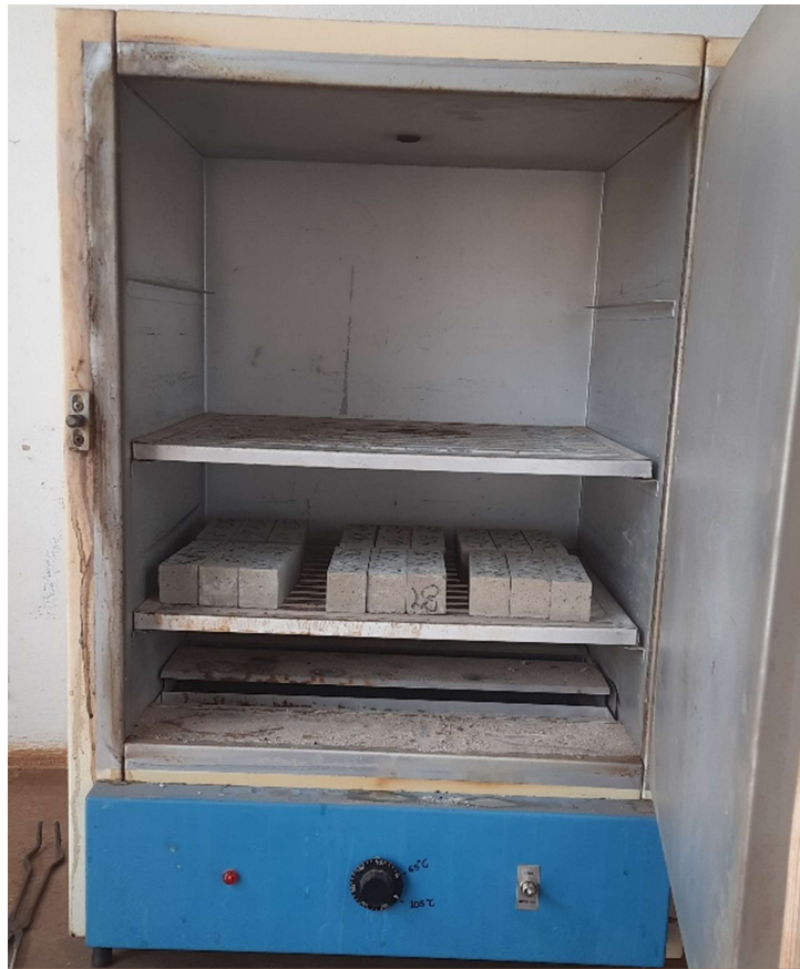
Figura 22 - Corpos de prova submetidos em estufa à temperatura de 105^{\circ}\text{C} \pm 5
