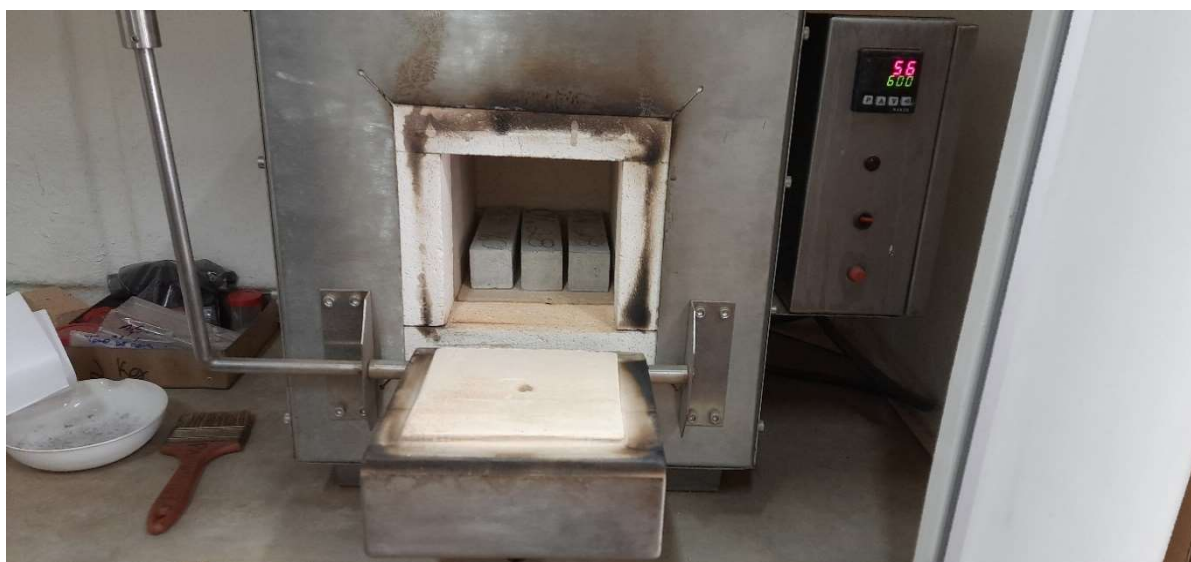
Figura 25 - Corpos de provas submetidos na múfla à 600 °C
