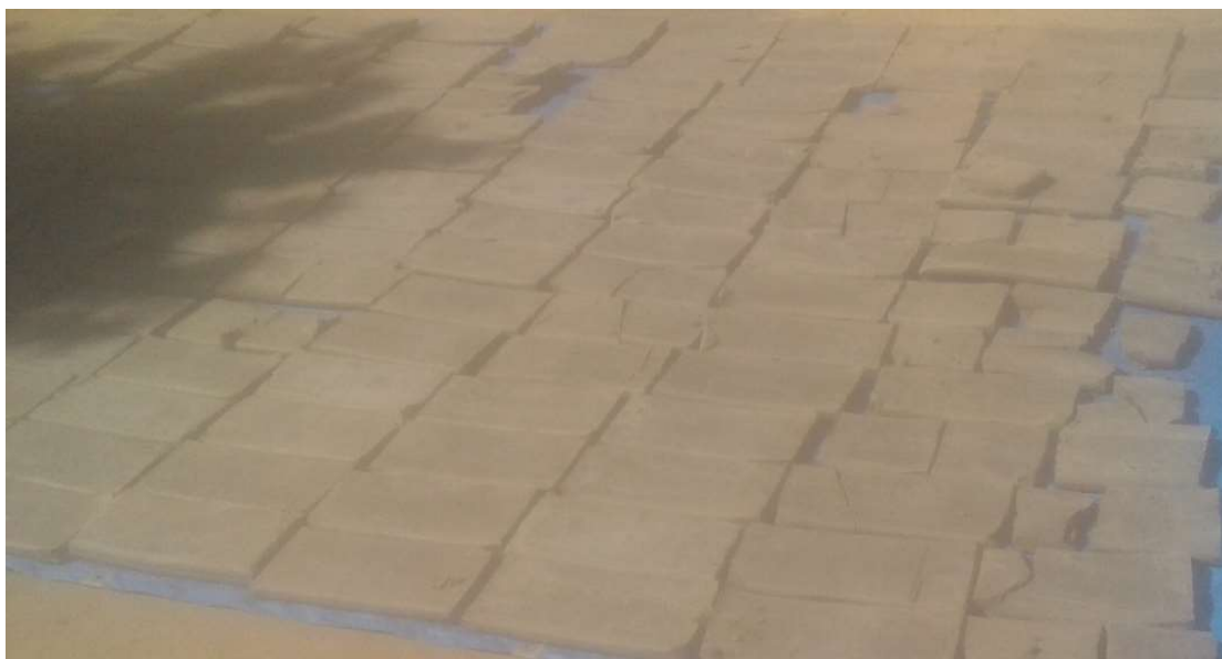
Figura 16 - Processo de secagem da argila à céu aberto
