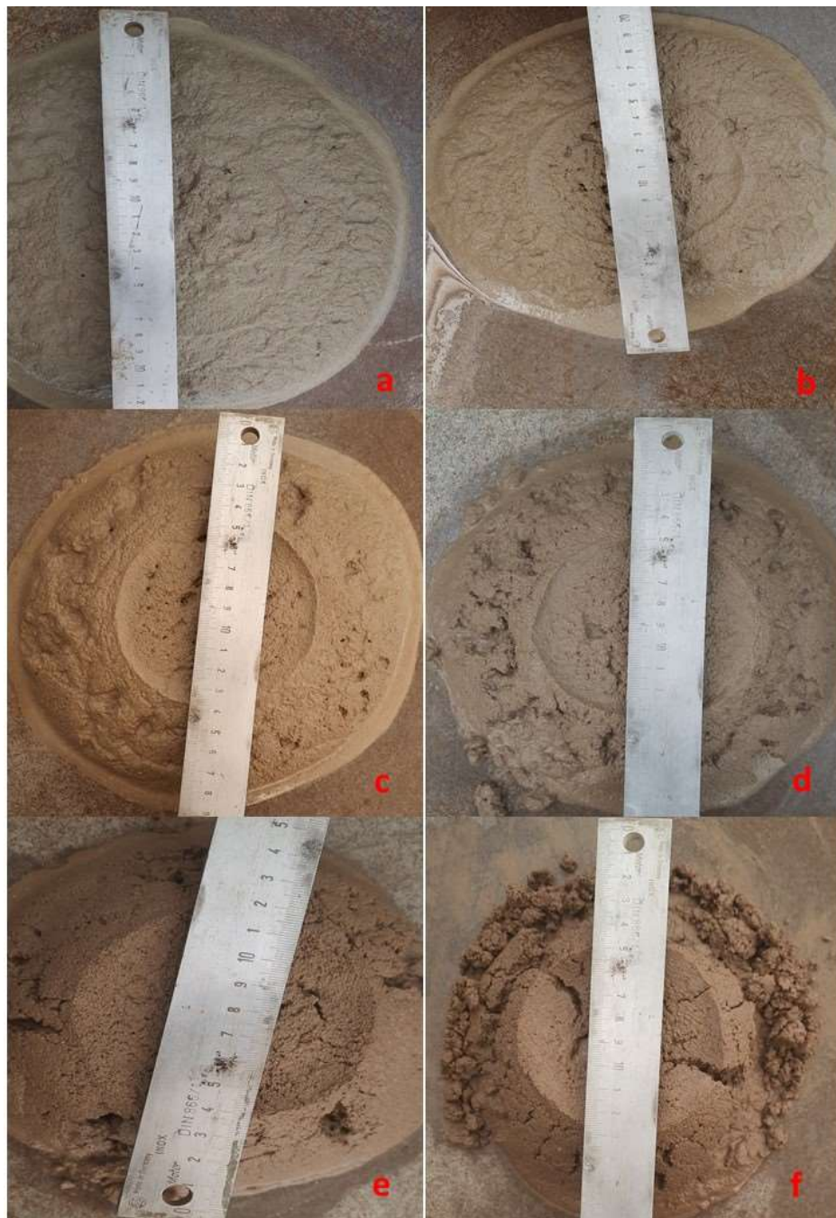
Figura 21 - Ensaio de índice de consistência
