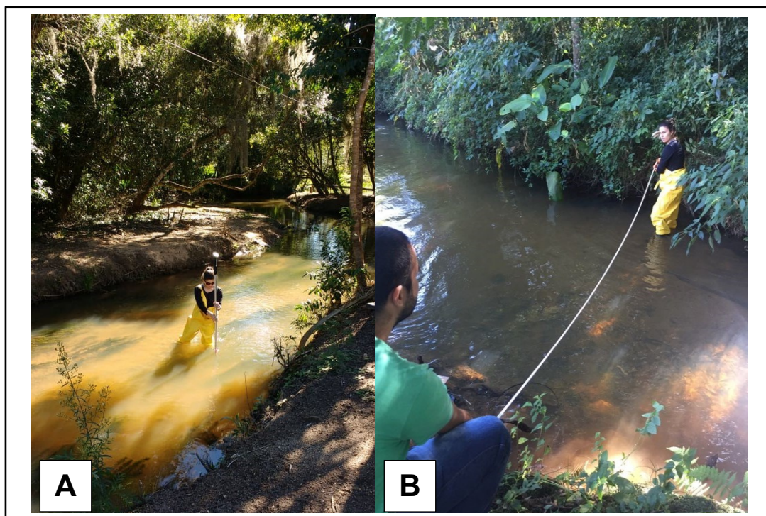
Figura 9. [A] Medições de fluxo sendo realizadas, [B] Medições da seção transversal do rio Una, Ibiúna-SP, 2019.
