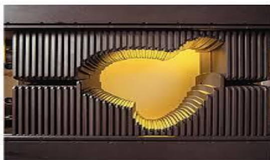
Figura 4 - Colimador multi-lâminas conformacionado na forma do volume-alvo.
